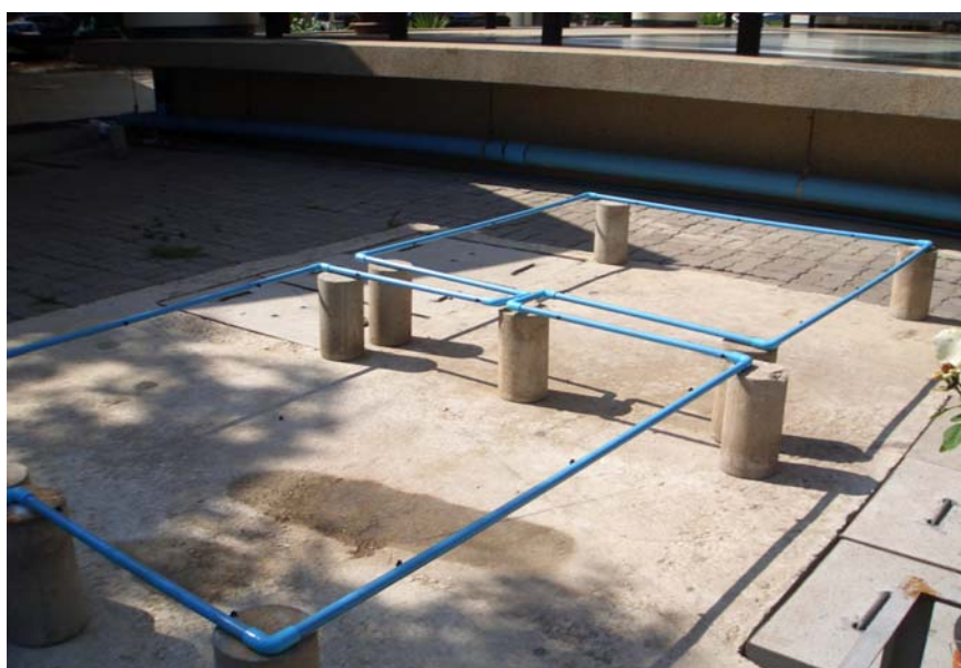
ภาพที่ 22 แสดงการจัดวางอุปกรณ์เพื่อหาค่าสัมประสิทธิ์การสูญเสียแรงดันกรณีน้ำไหลผ่านหัวฉีด สำหรับการทดลองรูปแบบที่ 3 (จำนวนหัวฉีด 27 หัวฉีด ความดัน 0.34475 บาร์ อัดสองทาง)
