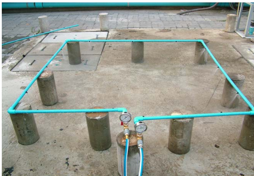
ภาพที่ 21 แสดงการจัดวางอุปกรณ์เพื่อหาค่าสัมประสิทธิ์การสูญเสียแรงดันกรณีน้ำไหลผ่านหัวฉีด สำหรับการทดลองรูปแบบที่ 2 (จำนวนหัวฉีด 13 หัวฉีด ความดัน 0.8 บาร์ อัดสองทาง)
