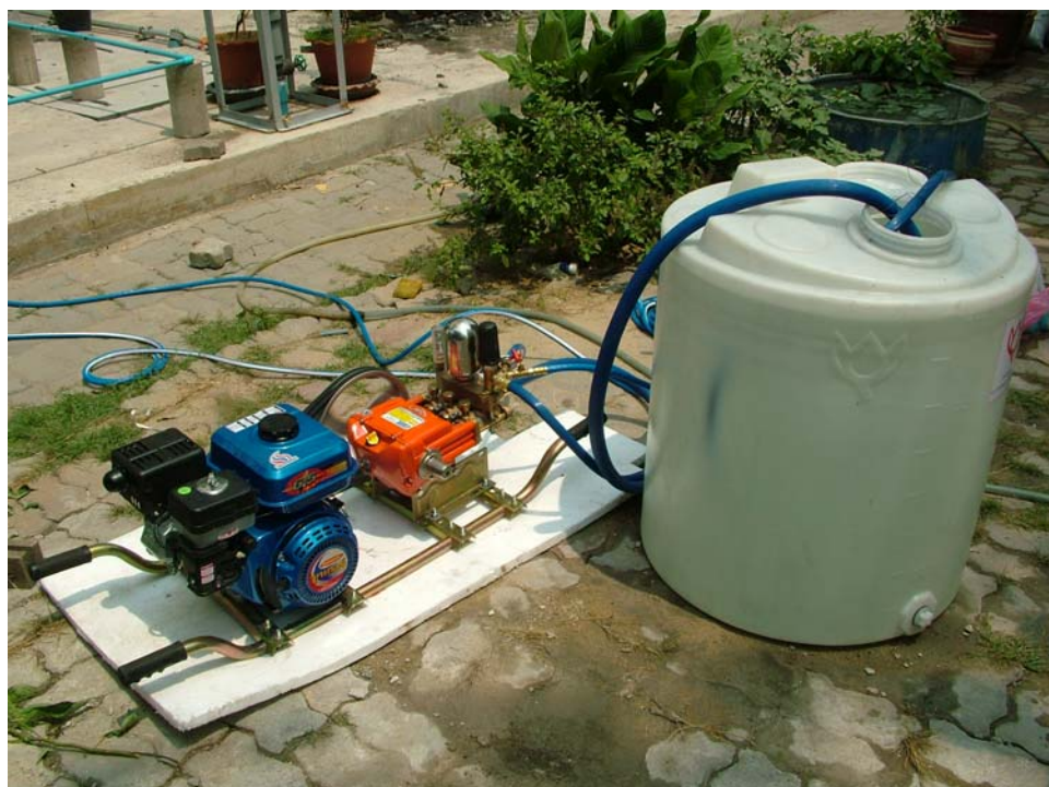
ภาพที่ 19 แสดงการเตรียมปั้มน้ำแรงดันสูงที่ต่อเข้ากับถังน้ำ 200 ลิตร
