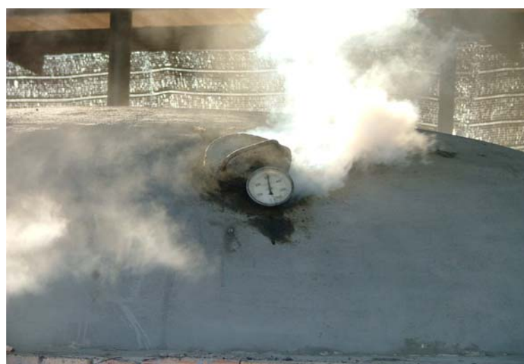
ภาพที่ 12 ภาพที่ใช้รองรับน้ำส้มควันไม้ดิบและการวัดอุณหภูมิภายในเตา ที่มา: สมาคมเทคโนโลยีที่เหมาะสม (2548)
