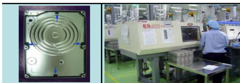
ภาพที่ 13 แสดงผลิตภัณฑ์ และลักษณะการทำงาน Top Cover Injection
