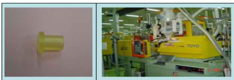
ภาพที่ 7 แสดงผลิตภัณฑ์ และลักษณะการทำงาน Stopper Injection
