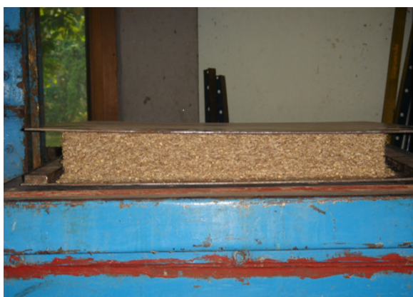
ภาพที่ 3.11 การเตรียมอัดแผ่นเส้นใยอัดด้วยเครื่องอัดไฮดรอลิก
