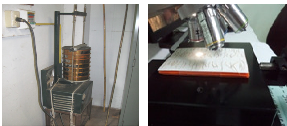
ภาพที่ 3.7 ตะแกรงร่อนและการวัดขนาดเส้นใย
