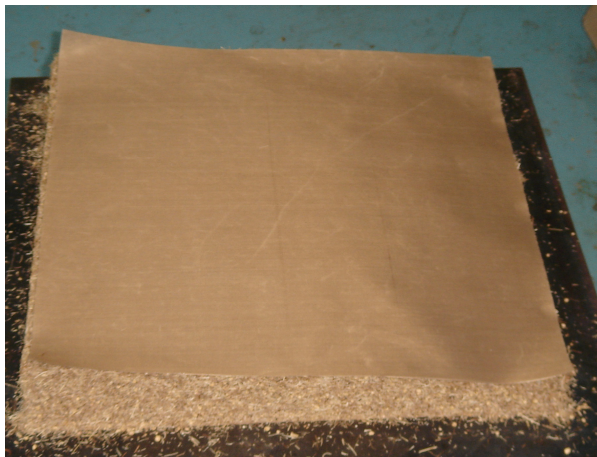
ภาพที่ 3.10 การฟอร์มแผ่นเส้นใยอัดจากเส้นใยมะพร้าวผสมตันรูปถาชี
