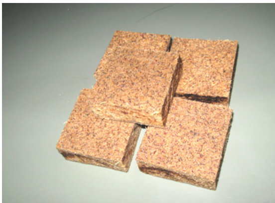
ภาพที่ 3.23 การพองตัวทางความหนาหลังแช่น้ำที่ 2 ชั่วโมง และ 24 ชั่วโมง
