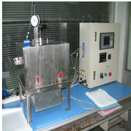
ภาพที่ 3.28 เครื่องทดสอบค่าสัมประสิทธิ์การนำความร้อนและขึ้นตัวอย่างขึ้นทดสอบ
