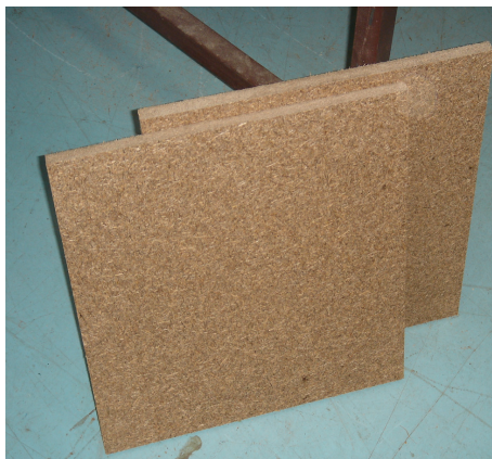
ภาพที่ 3.13 การปรับสภาวะอุณหภูมิของแผ่นเส้นใยอัดมะพร้าวผสมต้นธูปฤาษี
