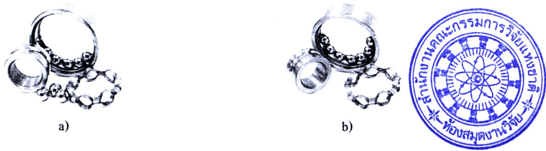
รูปที่ 3.7 โครงสร้างของแบริ่งที่ใช้ในการทดลอง a) 6202 ZZ b) 6201 ZZ
