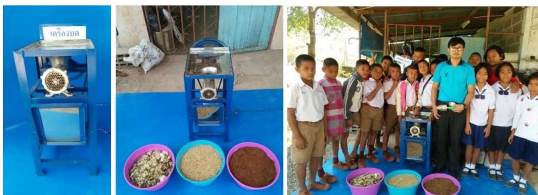
ภาพที่ 4.11 การทดสอบเบื้องต้นกับเครื่องจักรในการทดลองบดอัดและผสมส่วนประกอบดินเทียม
