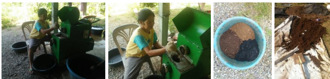
ภาพที่ 4.23 กระบวนการแยกและย่อยขยะเปียกโดยผสมผสานกับเศษเหลือทิ้งจากเกษตรกรรม
