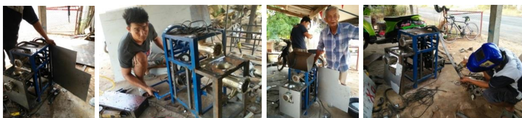
ภาพที่ 4.18 ขั้นตอนการประกอบส่วนต่างๆเพื่อทดสอบการใช้งานจริงเบื้องต้นก่อนการประกอบ เปลี่ยนนอกเพื่อป้องกันอันตรายจากการใช้งานเครื่องบดและอัดเม็ดดินเทียมเพื่อการอบแห้ง
