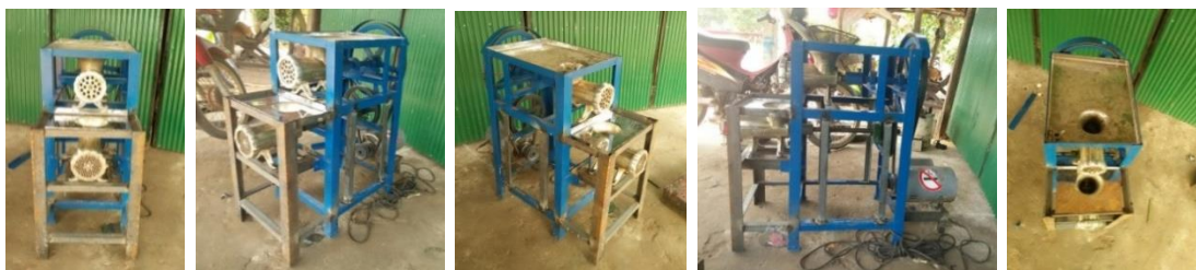
ภาพที่ 4.19 ขั้นตอนการประกอบส่วนโครงสร้างหลักและส่วนของมอเตอร์ขับเคลื่อนด้วยสายพาน ในส่วนของการเชื่อมต่อโครงสร้างและติดตั้งจุดยึดติดบริเวณด้านข้างของเครื่องจักร
