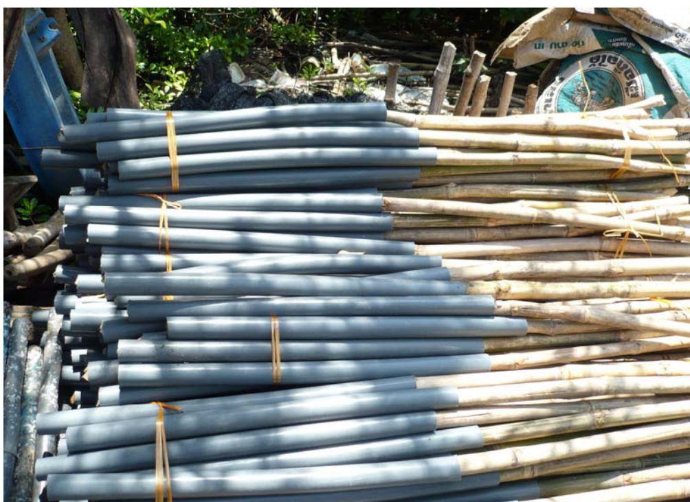
ภาพที่ 5 ลักษณะของไม้ไผ่ที่สวมทับด้วยท่อพีวีซี
