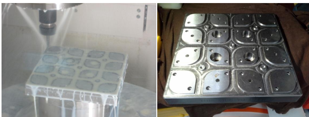
รูปที่ 4.19 Fixture สำหรับจับยึดแผ่นสแตนเลสชนิดมันเงา
