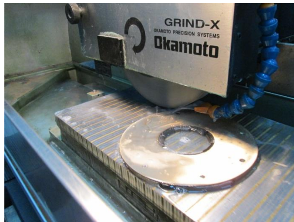
รูปที่ 4.12 การยัดแผ่นทองเหลืองเข้ากับระบบ Jig Fixture บนแท่นเครื่องเจียรราบ
