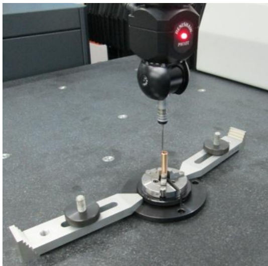
รูปที่ 4.5 ตรวจสอบเส้นผ่านศูนย์กลางของสลักที่กลึงได้ด้วยเครื่อง CMM
