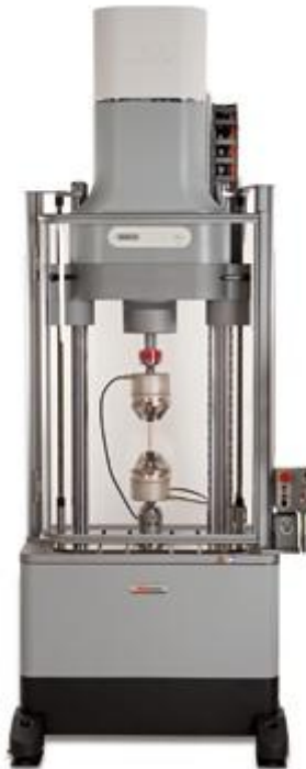
รูปที่ 4.23 การทดสอบค่าความแข็งแรงของสปริงเหนียวด้วยเครื่องดึง Tensile Test Machine
