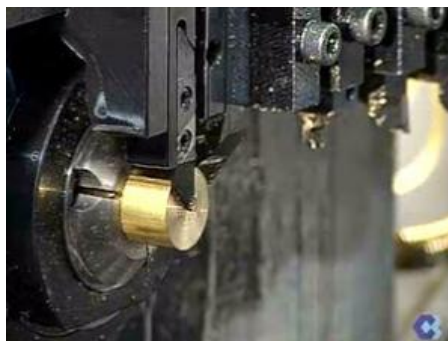
รูปที่ 4.4 ลักษณะการกลึงชิ้นงานขนาดเล็กด้วยเครื่องกลึง CNC Swiss Type Lathe
