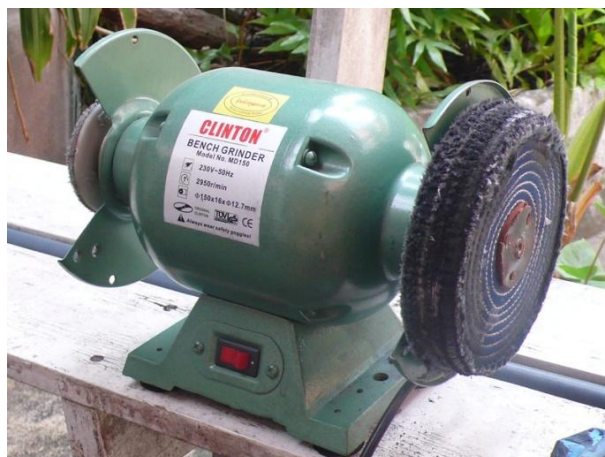
รูปที่ 4.16 เครื่องขัดเงา Side Cover Plate ด้วยลูกฟัก
