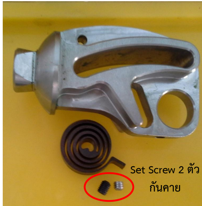
รูปที่ 5.5 การล็อกสองชั้นเพื่อให้สปริงไม่คายนั้ขณะใช้งาน
