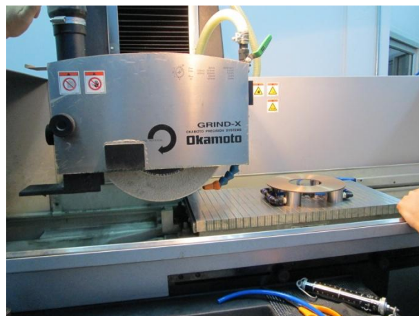
รูปที่ 4.10 การยึดแผ่นทองเหลืองเข้ากับระบบสุญญากาศบนแท่นเครื่องเจียรราบ
