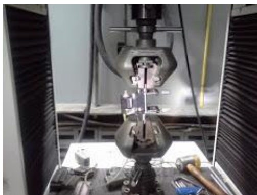
รูปที่ 4.32 การทดสอบความแข็งแรงของสแตนเลสหล่อ 309 โดยใช้เครื่อง Tensile Test
