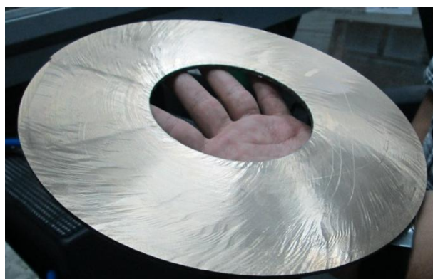
รูปที่ 4.8 วัตถุดิบเพลาทองเหลืองลายเสือที่ผ่านกระบวนการ Groove จนได้เป็นแผ่น
