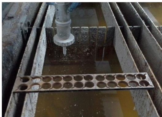
รูปที่ 4.29 การตัดสปริงตามที่ได้ออกแบบด้วยเครื่อง Waterjet
