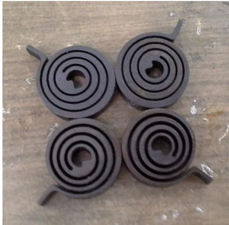
รูปที่ 4.30 สปริงที่ผ่านการตัดด้วย Waterjet และรมดำจนพร้อมใช้งาน
