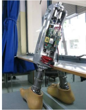
รูปที่ 2.5 ขาเทียมแบบปรับอัตราหมุนซึ่งควบคุมด้วยระบบอิเล็กทรอนิกส์
