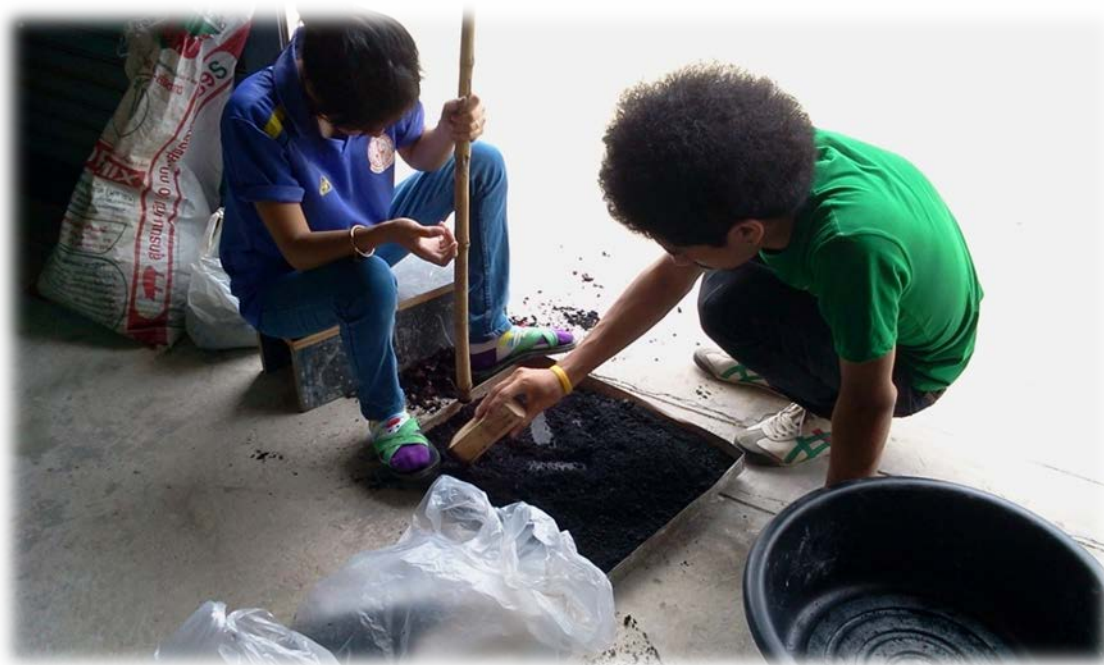
ภาพที่ ข 7 เผาและบดกากของเสียจากการเพาะเห็ดฟางก่อนนำไปอัดแท่ง
