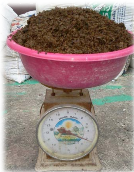
ภาพที่ ข 1 ชั่งน้ำหนักกากของเสียจากการเพาะเห็ดฟาง แล้วนำมาผสมกับแป้งมันสำปะหลังตามสัดส่วน
