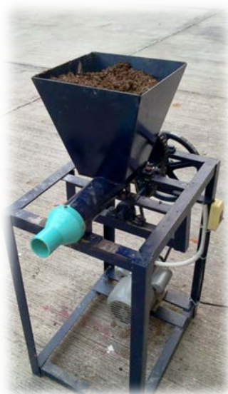
ภาพที่ ข 2 นำมาอัดแท่งด้วยเครื่องอัดแบบสกรู
