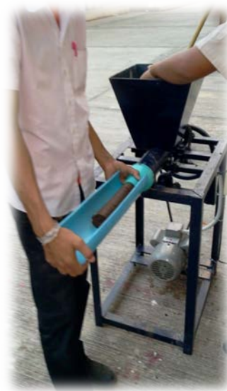
ภาพที่ ข 2 นำมาอัดแท่งด้วยเครื่องอัดแบบสกรู
