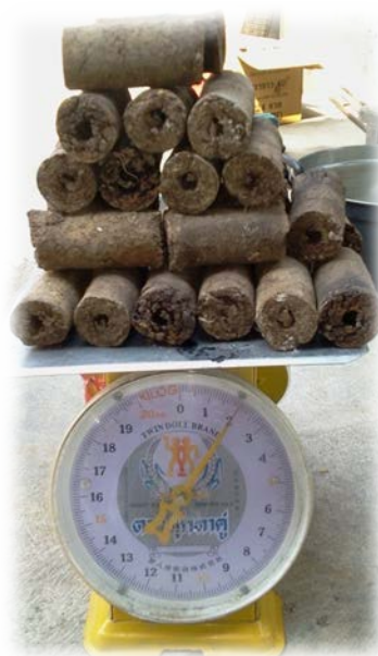
ภาพที่ ข 4 นำแท่งเชื้อเพลิงมาชั่งก่อนทำการทดลอง
