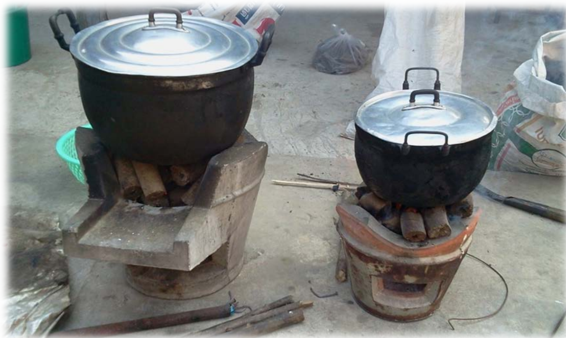
ภาพที่ ข 6 ทำการทดลองต้มน้ำหาค่าพลังงานความร้อน
