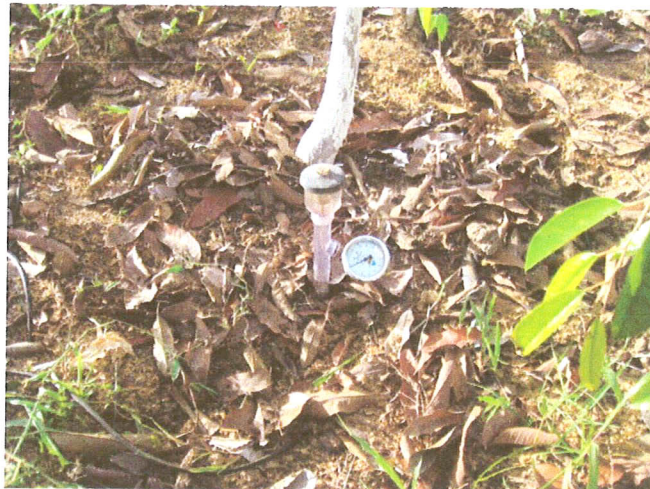
การวัดค่าความเครียดเมตริก ด้วย Tensiometer
