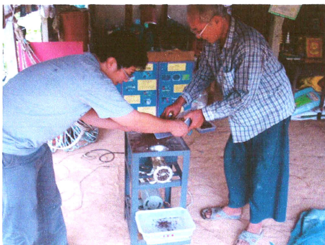
คณะผู้วิจัยและลูกพี่ร่วมกันผลิตดินเฝ้ารูปวงด้วยเครื่องบดเนื้อสัตว์
