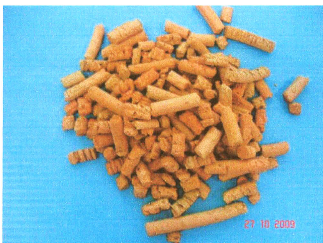
ดินเฝ้ารูปวงที่ขึ้นรูปจากเครื่องบดเนื้อสัตว์
