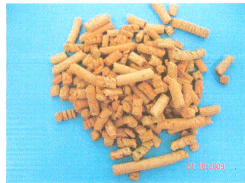
รูปที่ 5 การขึ้นรูปดินเผารูพรุนแบบโดยเครื่องอัดอาหารสัตว์ และดินเผารูพรุนหลังเผา
