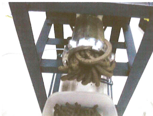
รูปที่ 5 การขึ้นรูปดินเผารูพรุนแบบโดยเครื่องอัดอาหารสัตว์ และดินเผารูพรุนหลังเผา
