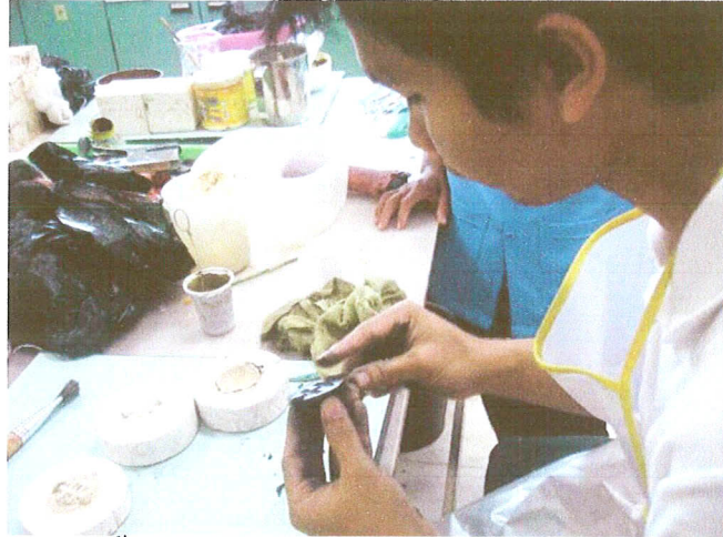
การขึ้นรูปดินเผารูปพญานาคด้วยแม่พิมพ์ปูนปลาสเตอร์
