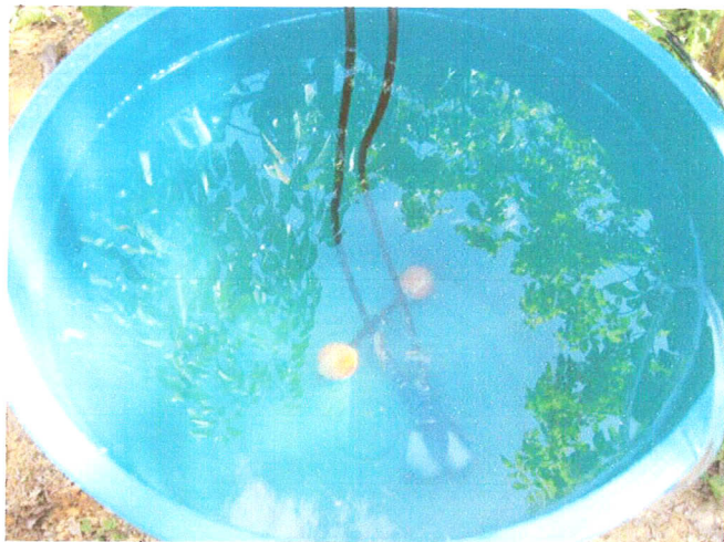
ปลายสายยางส่งน้ำจะถูกพันด้วยสำลีเพื่อกรองน้ำก่อนส่งให้ดินเผารูปวง
