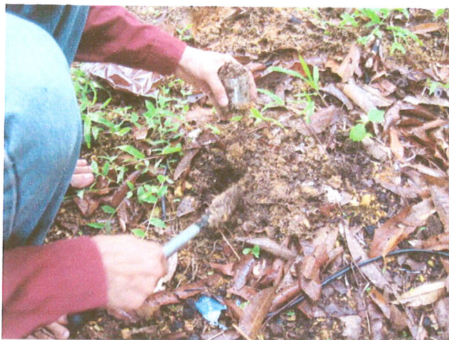
เก็บตัวอย่างดินใต้ต้นทุเรียนด้วยกระบอกลักเก็บดิน
