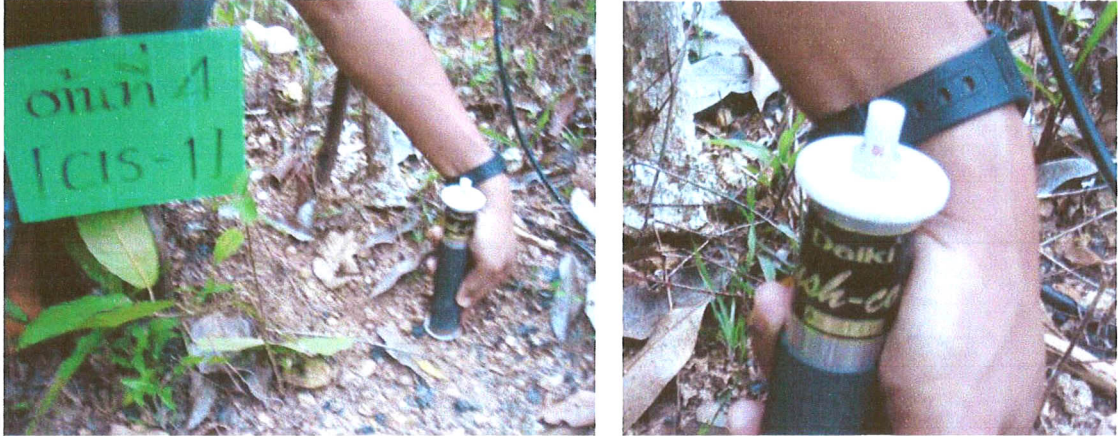
รูปที่ 58 การตรวจวัดค่าความแข็งของหน้าดินด้วย Soil hardness meter
