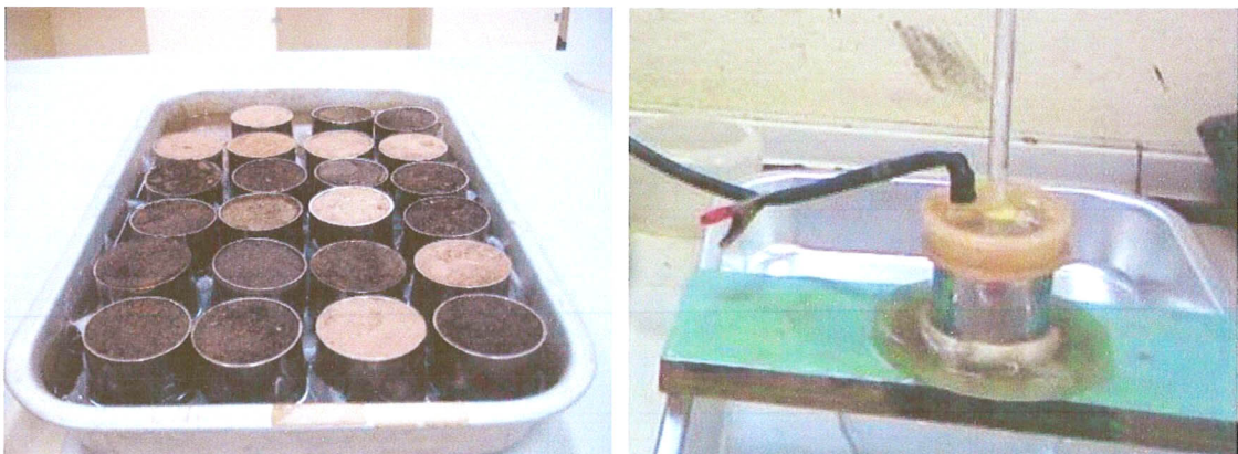
รูปที่ 13 ตัวอย่างดินในกระบอกเก็บตัวอย่างและการวัดการไหลซึมผ่านน้ำของดิน
