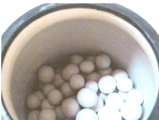
รูปที่ 16 หม้ออบและผสมดิน (mill ball) และลูกบดขนาดต่างๆ
