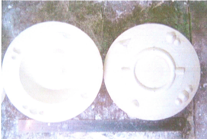
รูปที่ 28 แสดงลักษณะแบบพิมพ์ปูนปลาสเตอร์ครึ่งสี่หวทรวงแหวน
