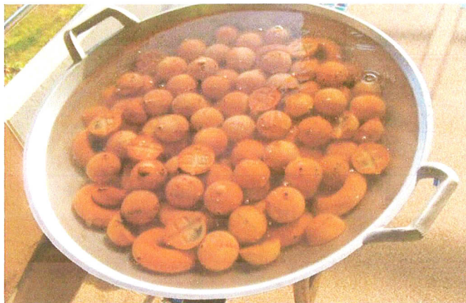
รูปที่ 20 แสดงการทดสอบการดูดซึมน้ำของแท่งทดสอบ และดินเผารูปนหลังการเผา
