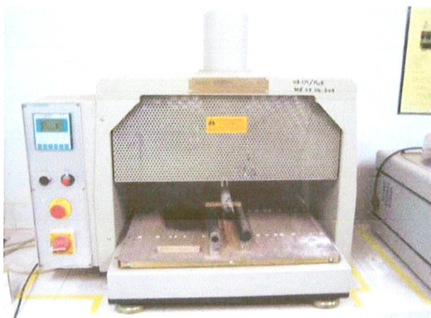
รูปที่ 19 แสดงการทดสอบความแข็งแรงของแท่งทดสอบดินเผาหลังการเผา
