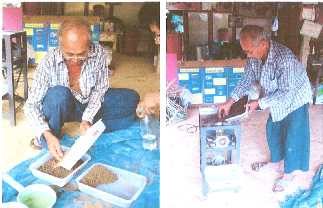
รูปที่ 119 การผสมส่วนผสมการขึ้นรูปดินเหนียวให้เป็นก้อนโดยใช้เครื่องอัดอาหารสัตว์
