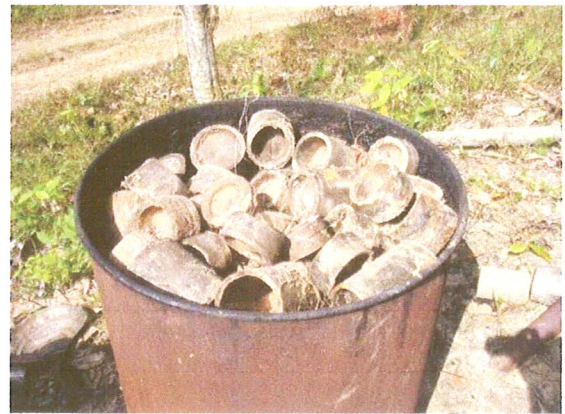
รูปที่ 115 การเตรียมดินเผากับข้อไม้ไฟในการเผาเพื่อผลิตดินเผารูปวงรีและน้ำส้มควันไม้
