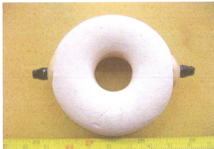
รูปที่ 25 แสดงลักษณะดินเผารูปวงแหวน (Porous ring, PR)
