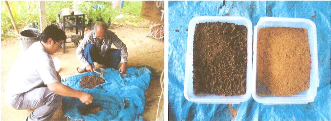
รูปที่ 118 การเตรียมส่วนผสมดินเหนียวและขี้เลื่อยไม่ไฟเพื่อการผลิตก้อนดินเผาภูพูน
