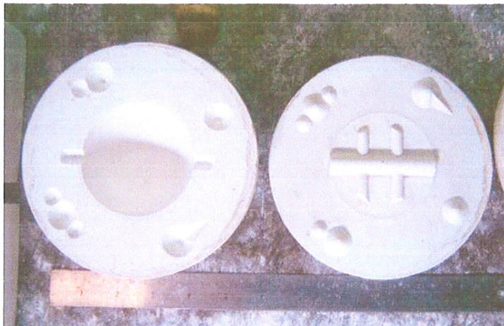
รูปที่ 29 แสดงลักษณะแบบพิมพ์ปูนปลาสเตอร์ครึ่งสี่หวทรวงกลม
