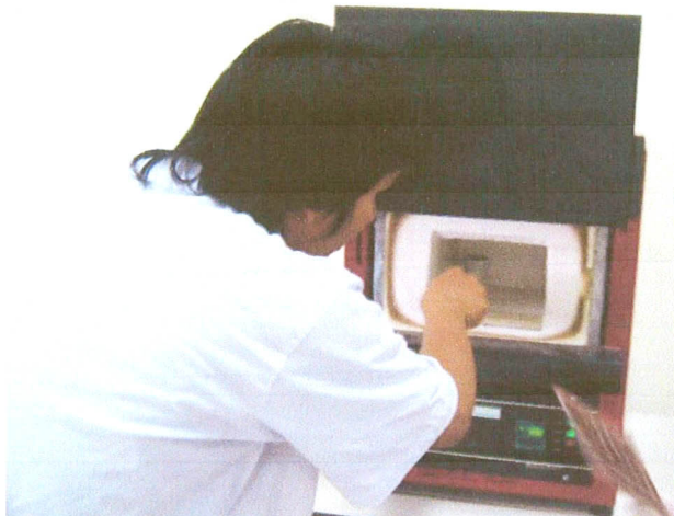
รูปที่ 17 แสดงการเผาแห้งทดสอบที่อุณหภูมิ 800 องศาเซลเซียส
