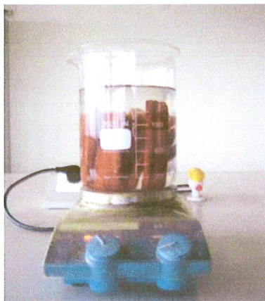
รูปที่ 20 แสดงการทดสอบการดูดซึมน้ำของแท่งทดสอบ และดินเผารูปนหลังการเผา
