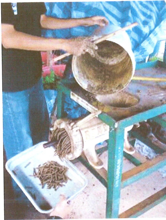
รูปที่ 120 การขึ้นรูปดินเหนียวให้เป็นท่อน โดยใช้เครื่องอัดอาหารสัตว์
