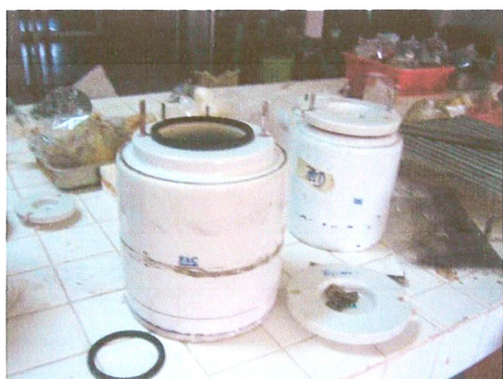
รูปที่ 16 หม้ออบและผสมดิน (mill ball) และลูกบดขนาดต่างๆ
