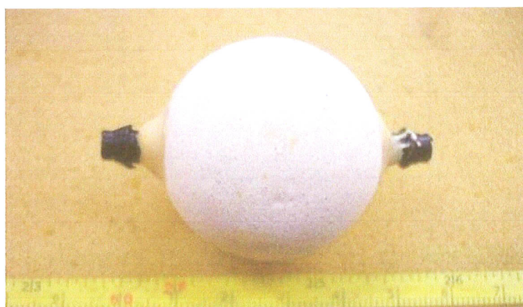
รูปที่ 24 แสดงลักษณะดินเผารูปทรงกลม (Porous ball, PB)
