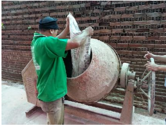
รูปที่ 4.15 แสดงกระบวนการผสมวัตถุดิบ (ซ้าย) และลักษณะของเนื้ออิฐพูนที่ได้จากการผสม (ขวา)
