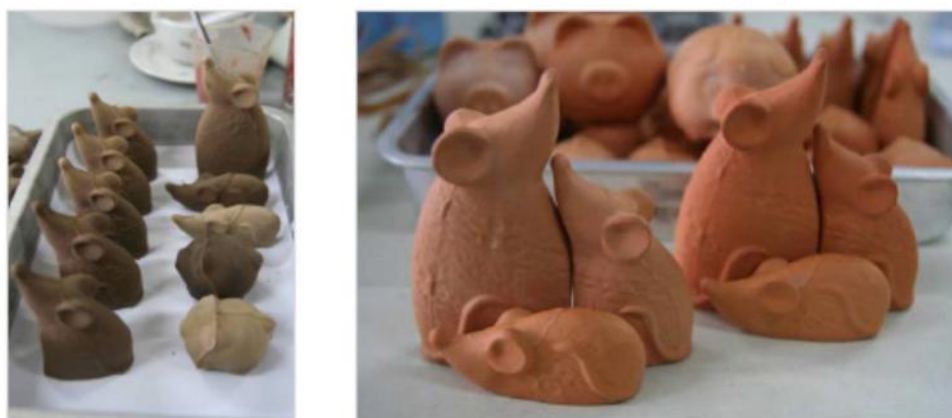
รูปที่ 3.3 ตัวอย่างชิ้นงานก่อนเผาและหลังเผา
