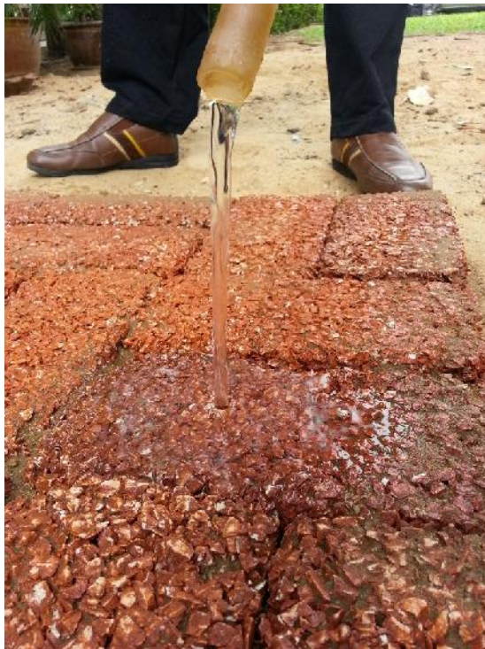
รูปที่ 4.18 แสดงการระบายน้ำของอิฐเซรามิกพรุน (ซ้าย) และลักษณะของการใช้งานรองรับน้ำหนักของอิฐเซรามิกพรุน (ขวา)
