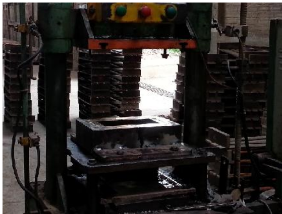
รูปที่ 4.16 แสดงเครื่องอัดขึ้นรูปที่ใช้ในโรงงานอุตสาหกรรม (ซ้าย) และลักษณะของอิฐพูนที่ได้จากการอัดขึ้นรูป (ขวา)
