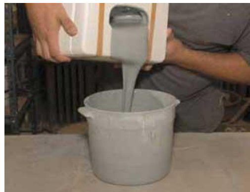
รูปที่ 2.6 รูปแสดงวิธีหล่อน้ำดิน
