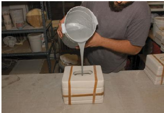
รูปที่ 2.6 รูปแสดงวิธีหล่อน้ำดิน
