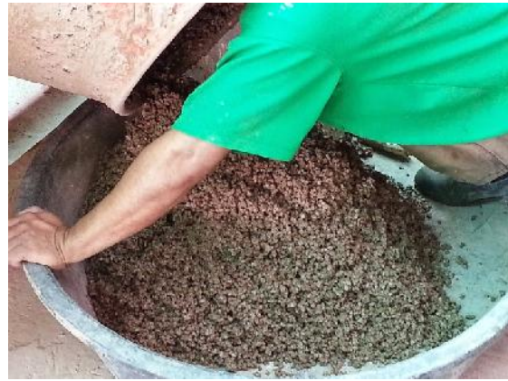
รูปที่ 4.15 แสดงกระบวนการผสมวัตถุดิบ (ซ้าย) และลักษณะของเนื้ออิฐพูนที่ได้จากการผสม (ขวา)
