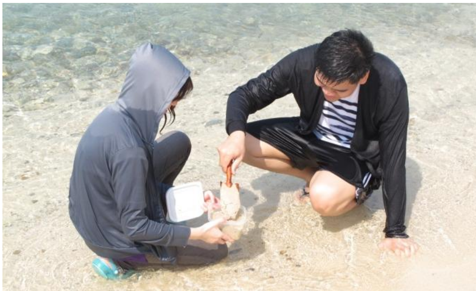
ภาพที่ 3 การเก็บตัวอย่างทรายโดยใช้ช้อนพรวนตักทรายที่ยังมีความชื้นหรือน้ำทะเลท่วมถึง
