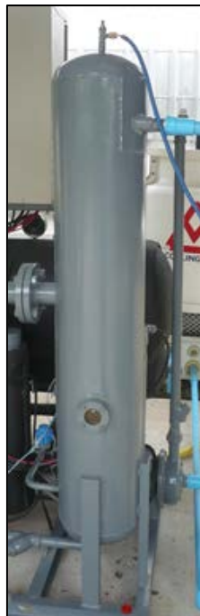
รูปที่ 3.5 เครื่องควบแน่น (Condenser)
