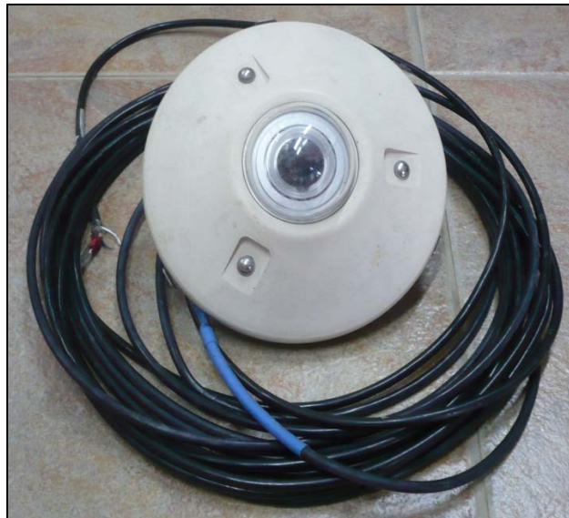
รูปที่ 3.15 อุปกรณ์วัดค่ารังสีอาทิตย์ชนิดรังสีรวม (Pyranometer) ยี่ห้อ KIPP & ZONE รุ่น CM11
