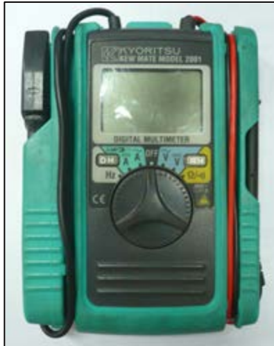
รูปที่ 3.14 เครื่องวัดพลังงานไฟฟ้า ยี่ห้อ KYORITSU รุ่น KEW MATE MODEL 2001
