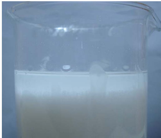
รูปที่ 6 หลังจากเติม 60% Ethanol แปะตตะกอนเป็นก้อนแยกชั้นจากสารละลายเมื่อปล่อยทิ้งไว้
