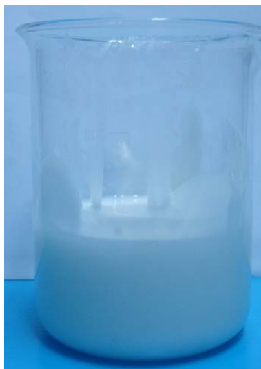
รูปที่ 3 แสดงแป้งข้าวเจ้าหลังจากเติม 3M NaOH แป้งพองตัวเป็นเจลสีขาวข้นหนืด
