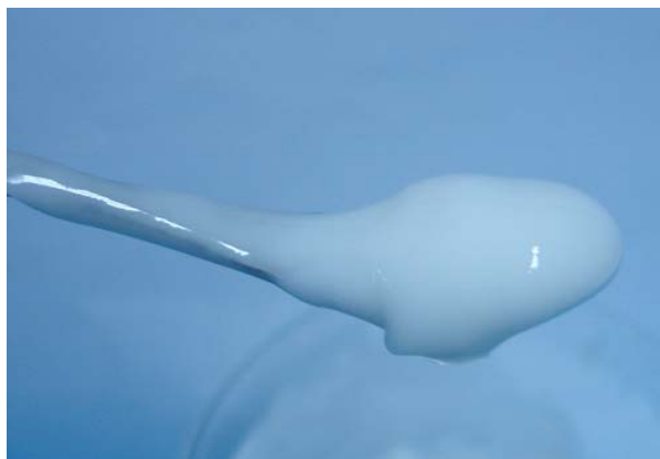
รูปที่ 4 แสดงแป้งข้าวเจ้าหลังจากเติม 3M NaOH แป้งข้นหนืดมากสามารถตักได้คล้ายโยเกิร์ต
