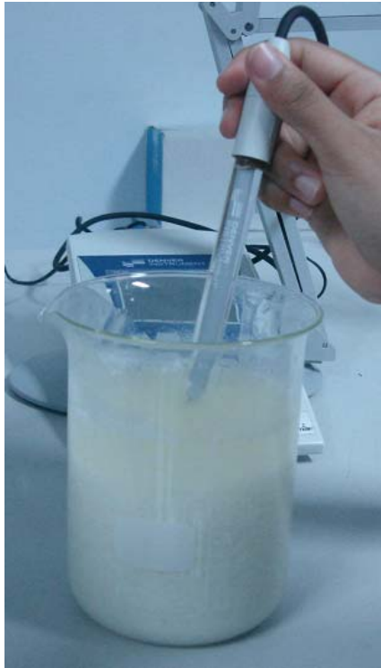
รูปที่ 7 ปรับ pH ตะกอนแบ่งให้ได้ pH 7
