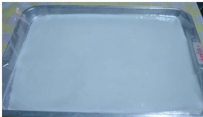
รูปที่ 8 นำตะกอนแบ่งที่ได้ไปอบในตู้อบ อุณหภูมิ 50^{\circ}\text{C} ช้ามคืน
