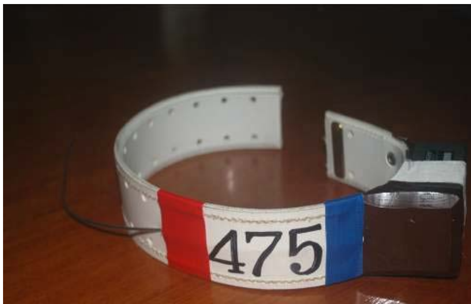
ภาพผนวกที่ 1 ปลอกคอส่งสัญญาณวิทยุ (radio collar) และเครื่องหมายแถบสีที่สามารถสังเกตได้ชัดเจน จากระยะไกล
