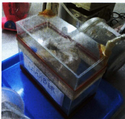
ภาพ 3.3 ภาชนะรมก๊าซโอโซนภายในบรรจุงูข้าวสารน้ำหนัก 1 กิโลกรัม ซึ่งมีดักแด้ของมอดพื้นเลื้อย Oryzaephilus surinamensis (Linnaeus) ปะปนอยู่
