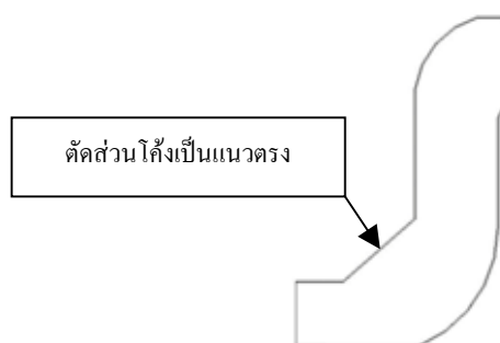
ภาพที่ 26 ท่อลมออกของการปรับปรุงครั้งที่ 3 (ขนาด 2.85 ม. x 2.2 ม.)
