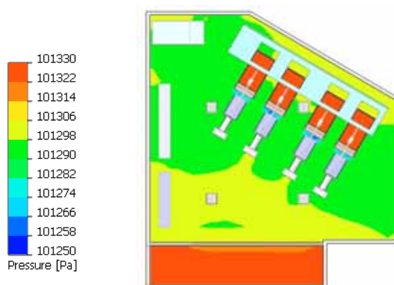
ภาพที่ 16 ความดันลดที่เป็นผลจากอัตราการไหล (มุมมองด้านบน +1.20 ม.)
