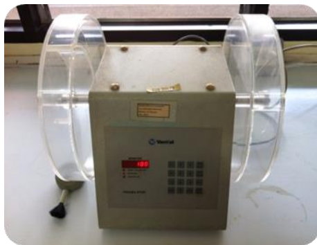
รูปที่ 2-4 เครื่องประเมินความกร่อนเม็ดยา
