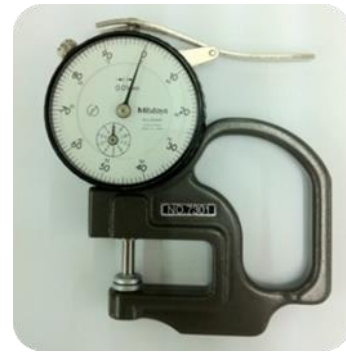
รูปที่ 2-3 เครื่องวัดความหนาเม็ดยา
