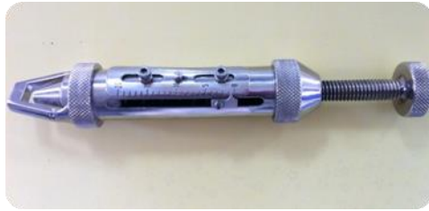
รูปที่ 2-2 เครื่องวัดความแข็งเม็ดยา
