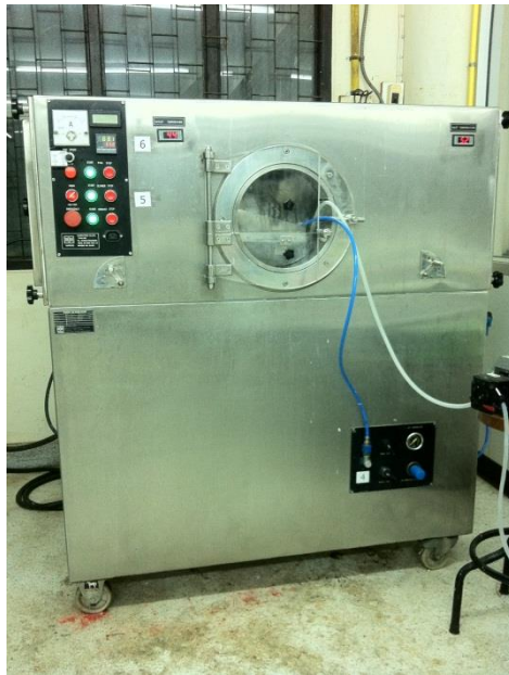
รูปที่ 2-7 เครื่องเคลือบยาเม็ด (Perforated pan coater)
