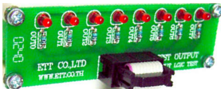
ภาพที่ ข-6 บอร์ดแสดงผลการทำงานของหุ่นยนต์ด้วย LED
