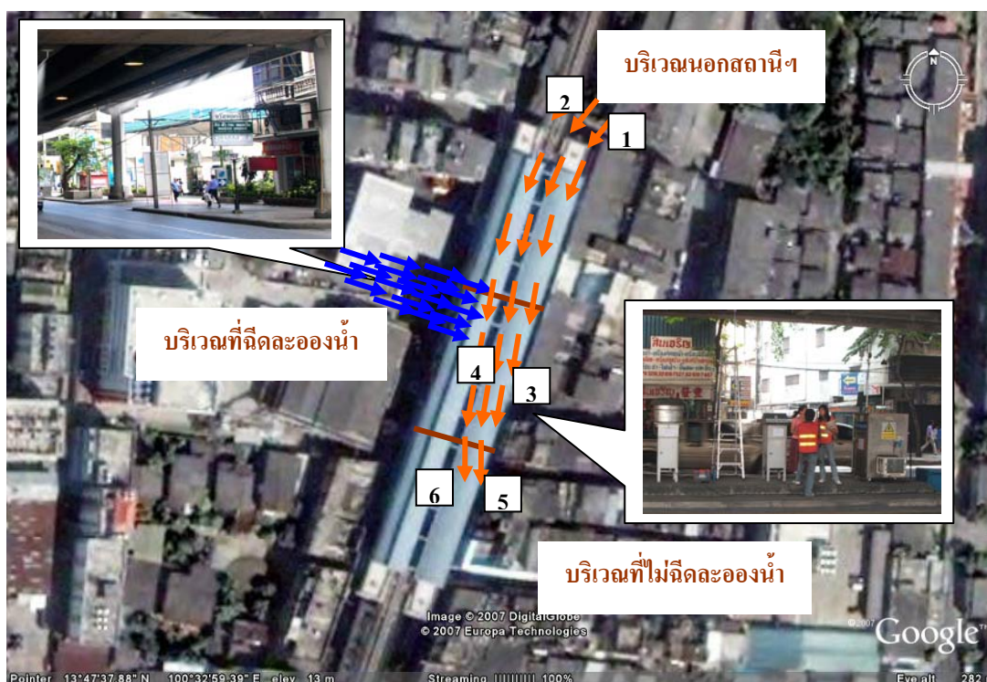
ภาพที่ 29 การเคลื่อนที่ของมวลอากาศจากทิศตะวันออกเฉียงเหนือบริเวณใต้โครงสร้างสถานีรถไฟฟ้าสะพานควาย
