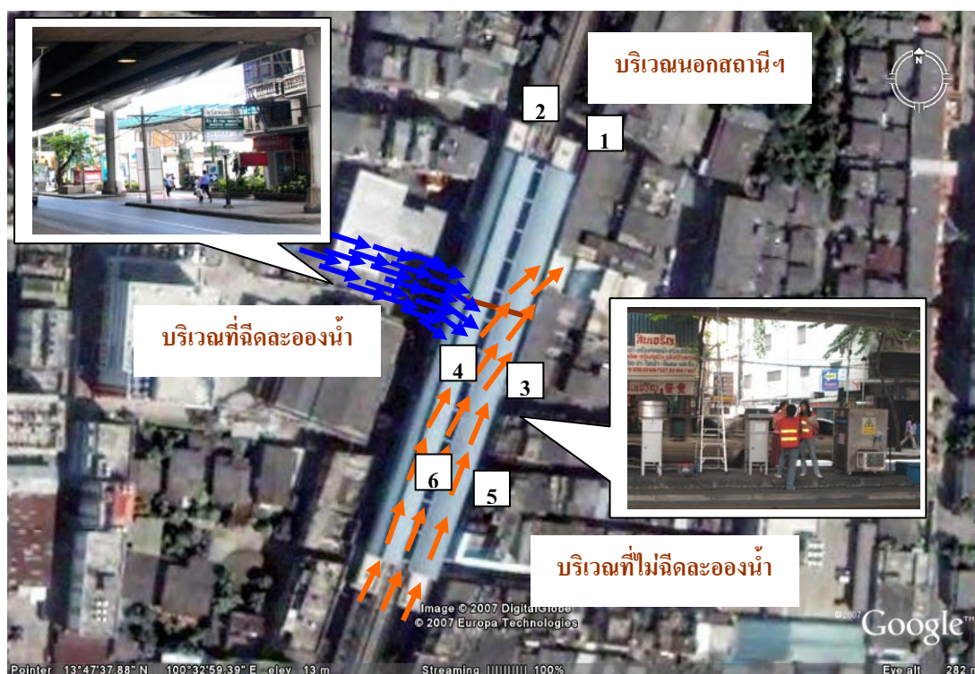
ภาพที่ 30 การเคลื่อนที่ของมวลอากาศจากทิศตะวันตกเฉียงใต้บริเวณใต้โครงสร้างสถานีรถไฟฟ้า สะพานควาย
