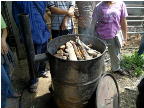
การนำไม้มาเผาเพื่อสกัดออกมาเป็นน้ำส้มควันไม้สำหรับ เป็นสารบำรุงดินและสารกำจัดศัตรูพืชและแมลง
