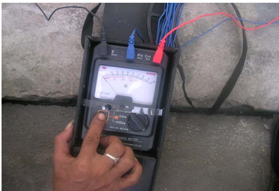
ภาพที่ 59 แสดงการวัดความต้านทานของดิน
