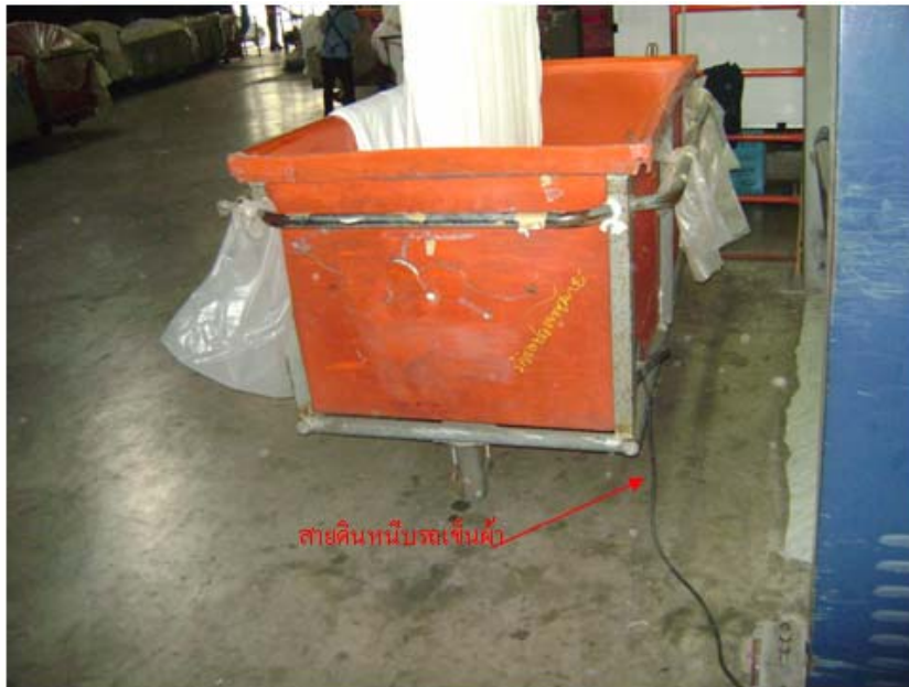
ภาพที่ 57 แสดงการต่อสายดินระหว่างทำงาน
