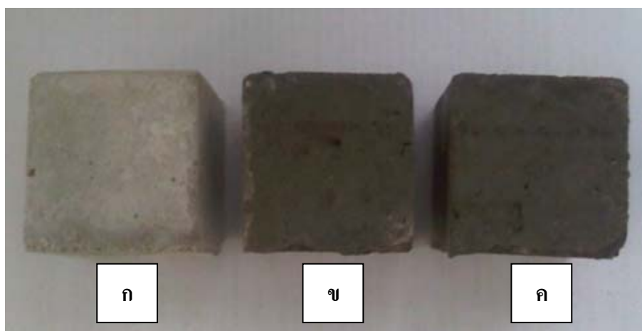
ภาพที่ 4.10 ก้อนตัวอย่าง ก) ซีเมนต์มอร์ตาร์ควบคุม ข) อัตราส่วน A1 (60:20:20) และ ค) อัตราส่วน B2 (70:10:20)
