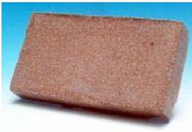
ภาพที่ 2.6 อิฐทนไฟซึ่งทำมาจาก metakaolin-geopolymer ผลผลิตจากวัสดุจีโอโพลิเมอร์ (ศักรินทร์ เหลืองกำจร, 2550:ออนไลน์)
