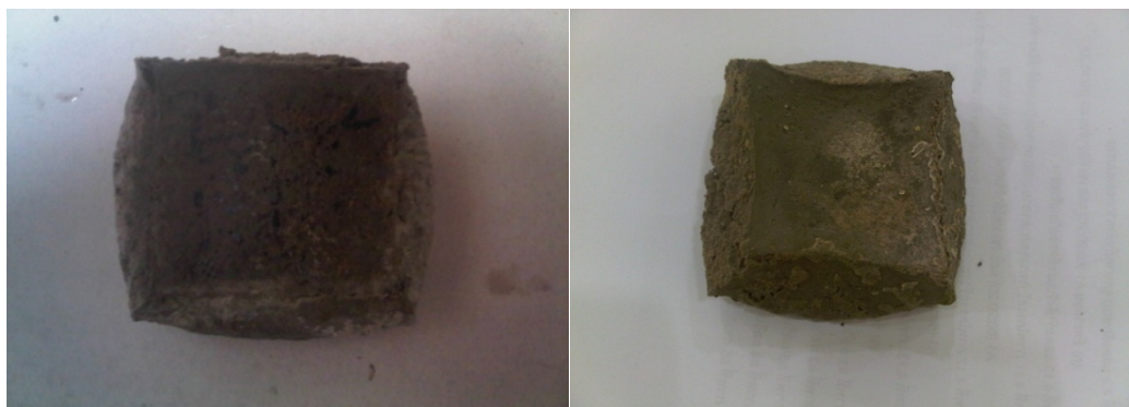
ภาพที่ 4.6 แสดงลักษณะผิอรูปร่างลูกบาศก์หลังจากถอดแบบของอัตราส่วนเสียซิลิกาและอะลูมินา บริสุทธิ์ ที่ 45:15 และ 53:17 (ก) อัตราส่วน A1 (60:20:20) และ (ข) อัตราส่วน B2 (70:20:10)
