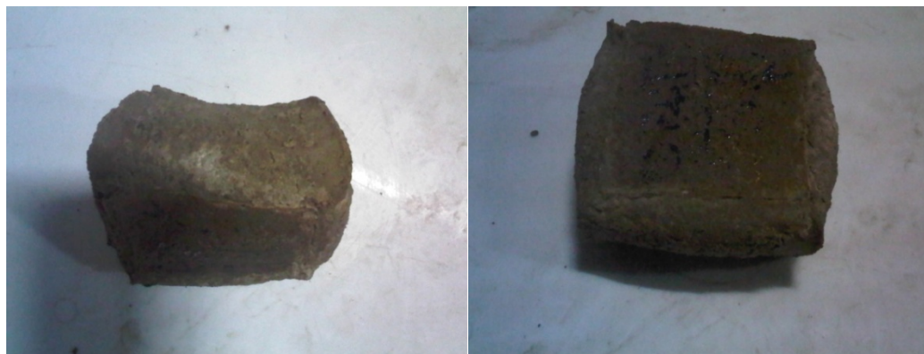
ภาพที่ 4.5 แสดงลักษณะผิอรูปร่างลูกบาศก์หลังจากถอดแบบของอัตราส่วนเสียซิลิกาและอะลูมินา บริสุทธิ์ ที่ 30:30 และ 35:35 (ก) อัตราส่วน A1 (60:20:20) และ (ข) อัตราส่วน B2 (70:10:20)
