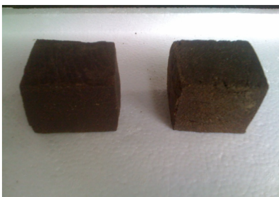
ภาพที่ 4.7 แสดงลักษณะรูปร่างลูกบาศก์หลังจากถอดแบบของอัตราส่วนเสียซิลิกาและอะลูมินา บริสุทธิ์ ที่ 40:20 และ 47:23 (ก) อัตราส่วน A1 (60:20:20) และ (ข) อัตราส่วน B2 (70:10:20)
