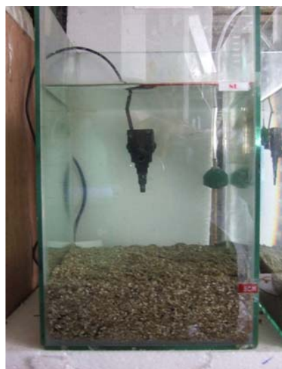
รูปที่ 3.6 แผนภาพและรูปถ่ายแสดงการติดตั้งชุดอุปกรณ์สำหรับถังดีไนทริฟิเคชัน (แสดงรายละเอียดสำหรับ 1 ชุดการทดลอง)
