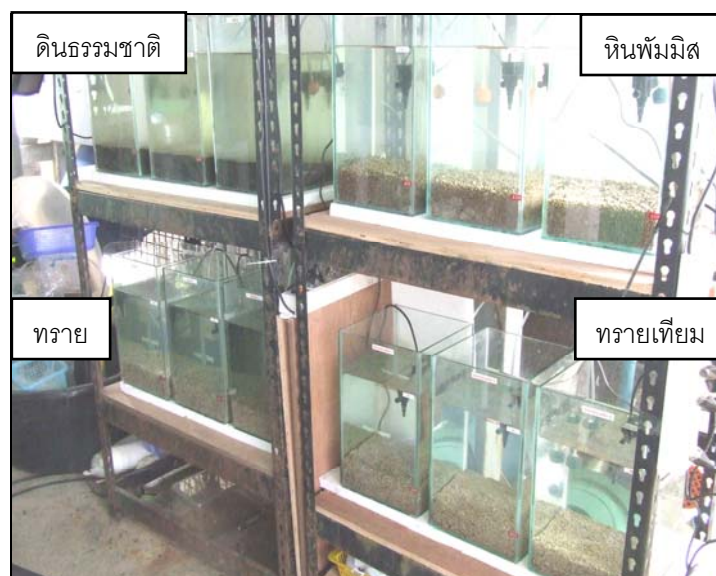
รูปที่ 3.7 ชุดการทดลองการบำบัดไนเตรตในถังดีไนทริฟิเคชันของดินธรรมชาติเปรียบเทียบกับวัสดุเพื่อทดแทนดิน 3 ชนิด ได้แก่ ทราย หินพัมมิส และทรายเทียม
