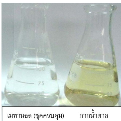
รูปที่ 4.14 ลักษณะและสีของน้ำหลังการบำบัดไนเตรตจากชุดที่เดิมเมทานอล (ชุดควบคุม) และกากน้ำตาลเป็นสารอินทรีย์คาร์บอน
