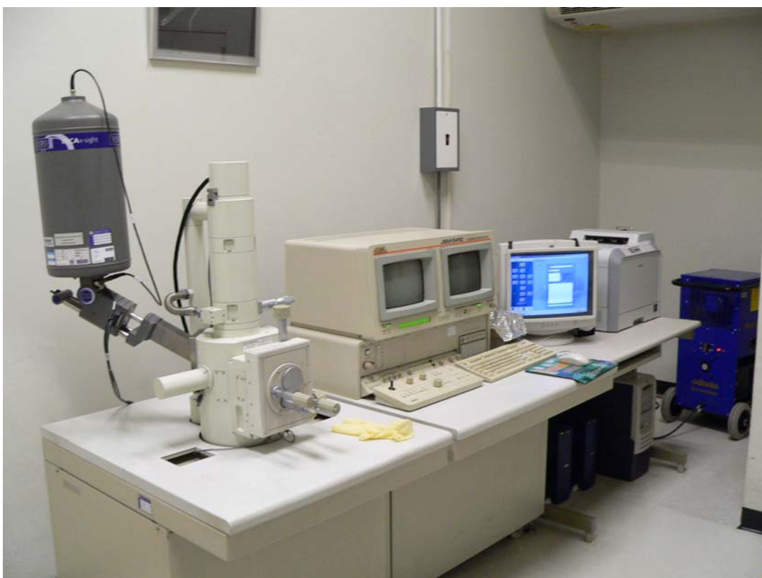
ภาพที่ 19 กล้องจุลทรรศน์อิเล็กตรอนแบบส่องกราด
