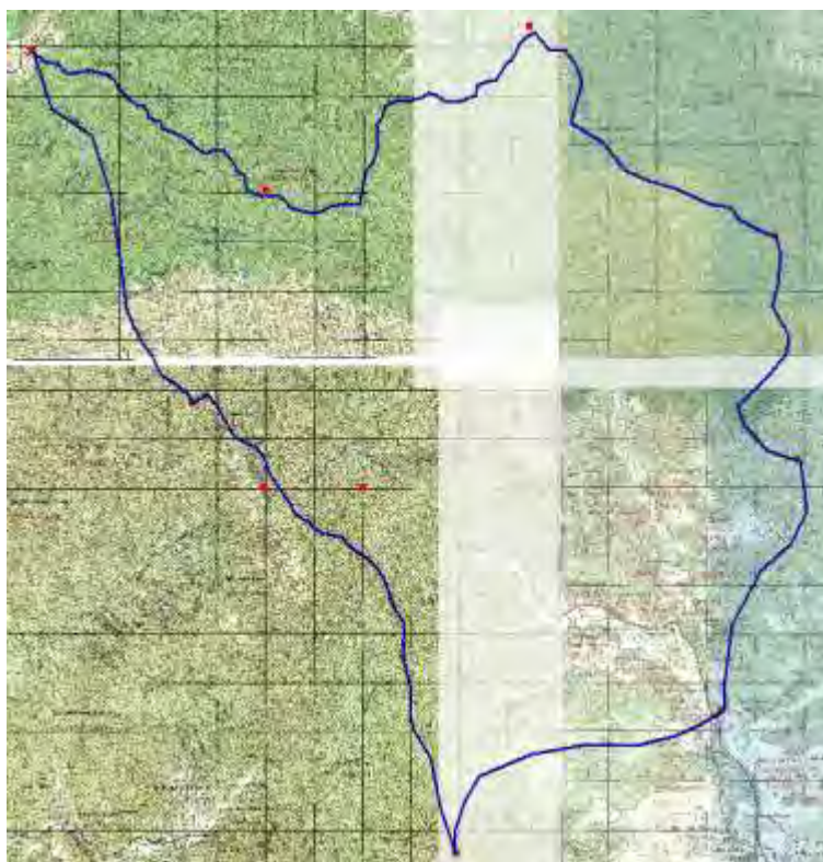
ภาพที่ 4.2 การสร้างชั้นข้อมูลระบบสารสนเทศภูมิศาสตร์ขอบเขตตำบลโดยอ้างอิงจากค่าพิกัดทางภูมิศาสตร์จากเอกสารแนบท้ายประกาศร่วมกับแผนที่ภูมิประเทศ
