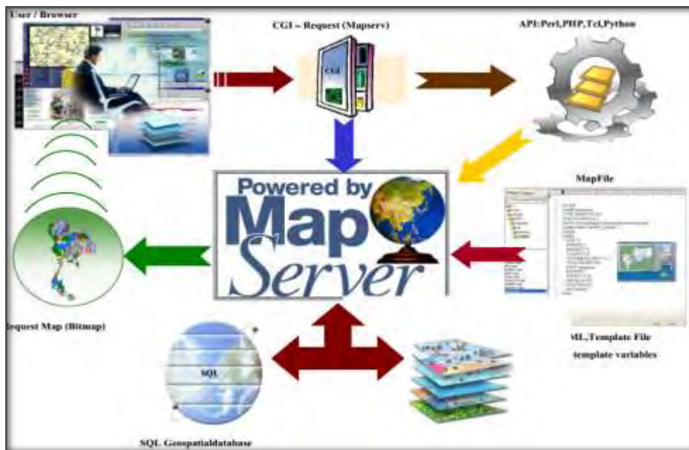
ภาพที่ 4.31 ลำดับการทำงานเบื้องต้นของโปรแกรม Minnesota MapServer
