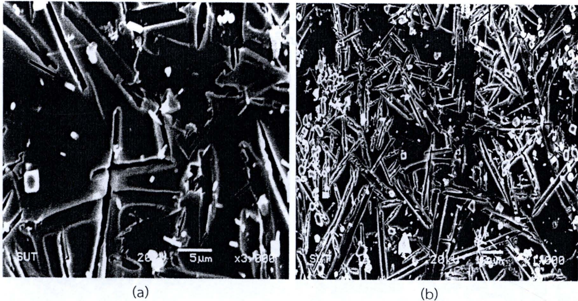
รูปที่ 4.9 Scanning electron microscope (SEM) ก่อนทดสอบความต้านทานการกัดกร่อนของเคลือบสูตร Z13 ที่ไม่ได้ทำการตกผลึก (recrystallization) ที่อุณหภูมิ 1050°C
