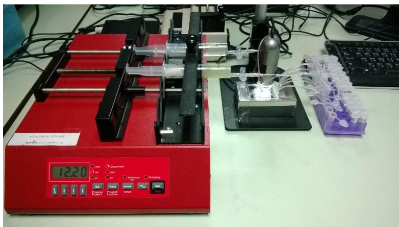
รูปที่ 8 แสดงการติดตั้งอุปกรณ์เข้ากับปั๊มอัตโนมัติเพื่อทดสอบการทำงาน
