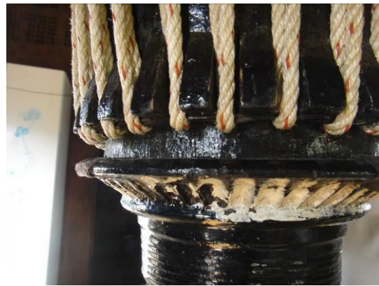
ภาพที่ ๒๕๒ การวางสายดิ่งหนังหน้ากลองลงร่อง เล็บช้างและขั้วกลอง
