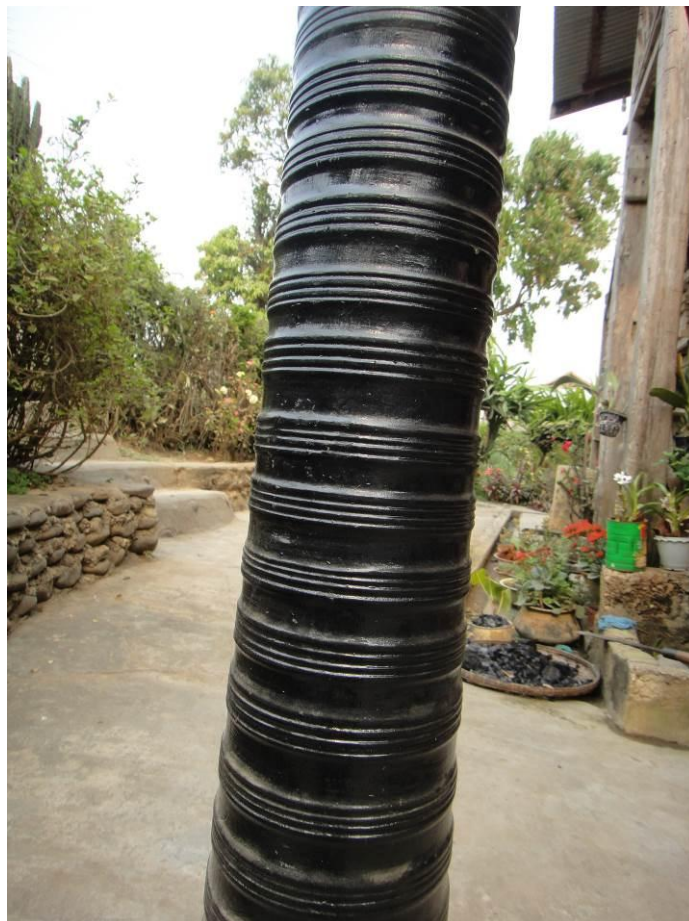
ภาพที่ ๒๖๐ การควั่นบากรอยลูกแก้วจากใต้อีวกลองถึงก้นก็
