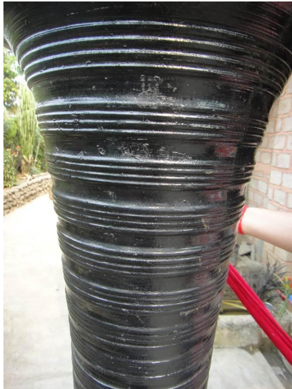
ภาพที่ ๒๖๘ การลดระดับของฐานไหกลอง การควั่นบากรอยลูกแก้วสู่เอวกลอง
