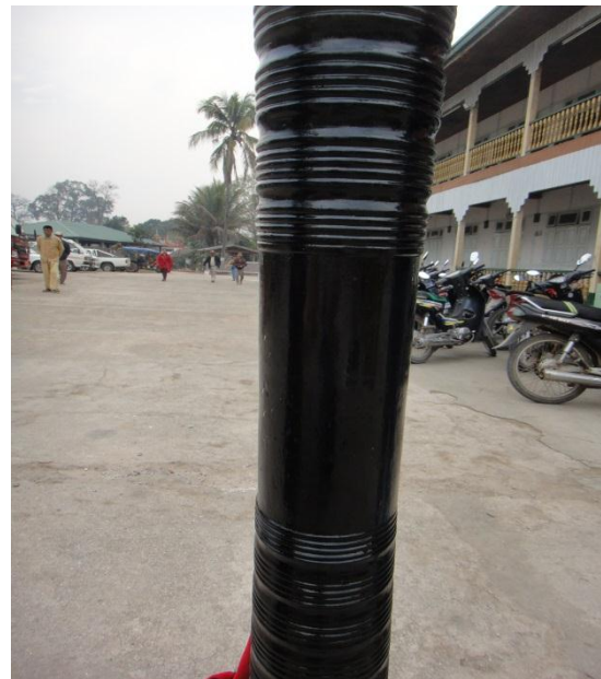
ภาพที่ ๓๕๐ การควั่นรอยดูกแก้วและแบ่งช่วงเอวกลอง
