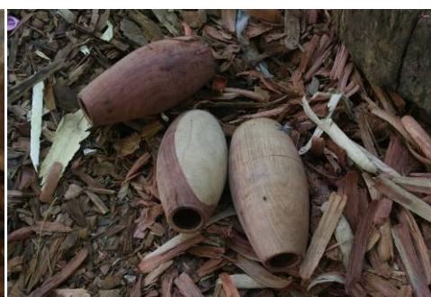
ภาพที่ ๒๔ (ซ้าย) การคว้านด้านในหุ่นกลอง (ขวา) หุ่นกลองเมื่อคว้านเสร็จเรียบร้อยแล้ว
