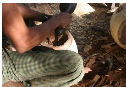
ภาพที่ ๒๔ (ซ้าย) การคว้านด้านในหุ่นกลอง (ขวา) หุ่นกลองเมื่อคว้านเสร็จเรียบร้อยแล้ว
