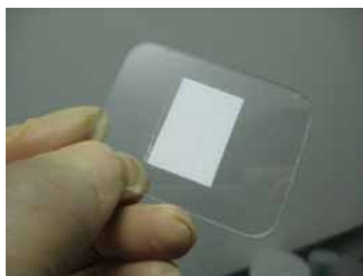
ภาพที่ 12 การเตรียม sample ที่เป็นผงลงบนกระจก slide สำหรับทดสอบด้วยเครื่อง XRD
