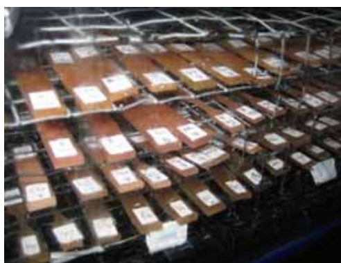
ภาพที่ 10 การวางชิ้นในตะแกรงลวดใน chamber ที่ควบคุมความชื้นสัมพัทธ์ 53%RH
