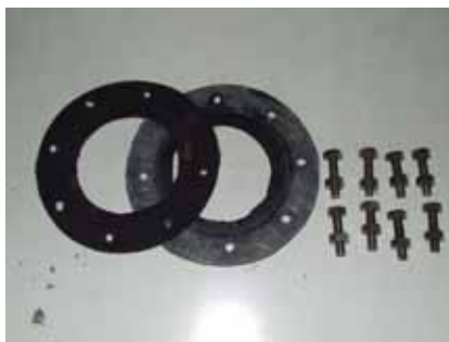
รูปที่ 3.34 แสดงปะเก็นและน็อตที่ใช้ในเครื่องไฟโรไลซิส
