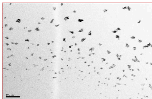
รูปที่ 4.13 แสดงภาพการวิเคราะห์ผลิตภัณฑ์ดีเซลด้วยเครื่อง TEM a) แสดงภาพถ่ายที่กำลังขยาย 100,000 เท่า b) แสดงภาพถ่ายที่กำลังขยาย 200,000 เท่า
