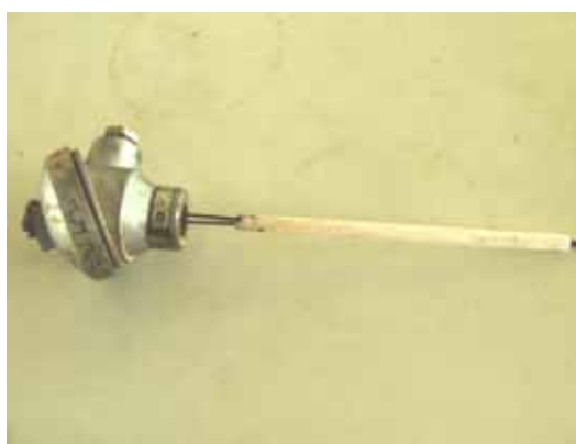
รูปที่ 3.42 แสดงเทอร์โมคัปเปิลที่อยู่ภายในเตาไฟโรไลซิส
