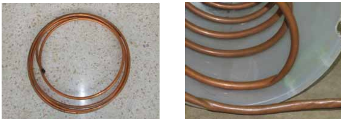
รูปที่ 3.40 แสดงท่อทองแดงที่ใช้ในการแลกเปลี่ยนความร้อน
