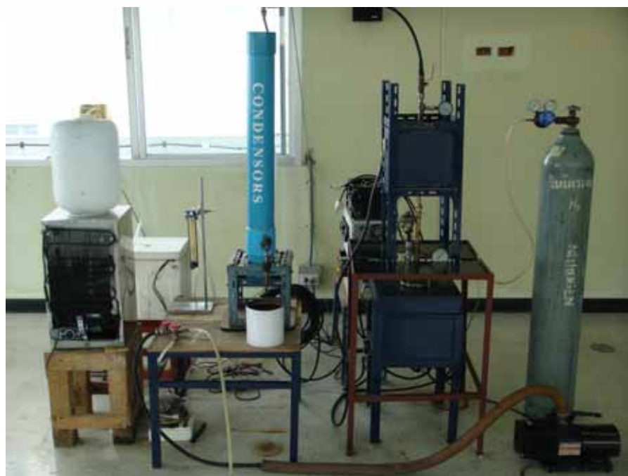
รูปที่ 3.46 แสดงการติดตั้งอุปกรณ์โดยรวมของเครื่องไพโรไลซิส
