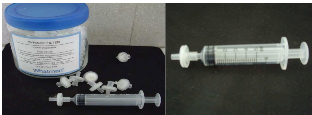
รูปที่ 4.17 แสดงหัวกรอง (Syringe filter) ในลอนของ Whatman ที่มีขนาดรูพรุน 0.2 \mu\text{m}
