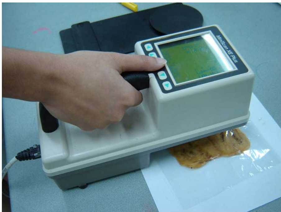
รูปที่ 3.70 แสดงการวัดสีกล้วยแผ่นด้วยเครื่องวัดสี Hunter lab รุ่น Miniscan XE Plus
