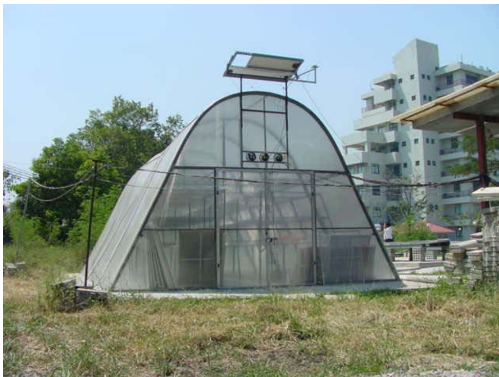
รูปที่ 2.25 ระบบอบแห้งแบบกรีนเฮาส์ที่พัฒนาโดย Janjai และคณะ (2007)
