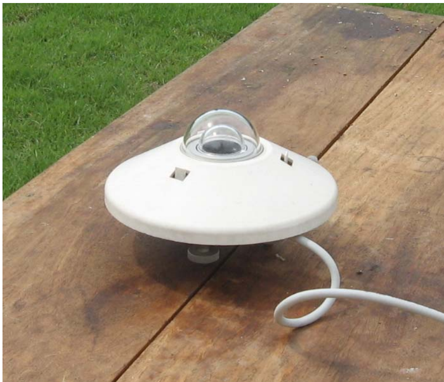
รูปที่ 3.11 ภาพถ่ายไพราโนมิเตอร์ ยี่ห้อ KIPP&ZONEN รุ่น CM11
