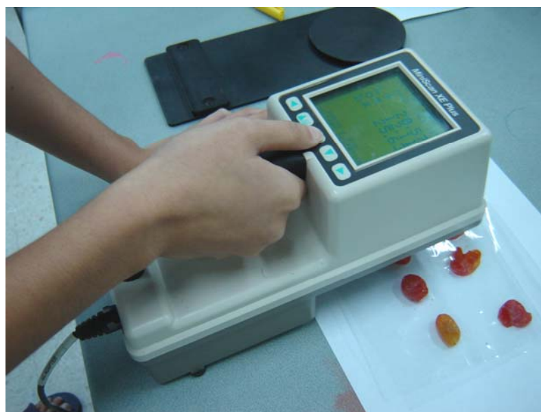
รูปที่ 3.44 การวัดสีมะเขือเทศแช่หมอนแห้งด้วยเครื่อง Hunter lab รุ่น Miniscan XE Plus
