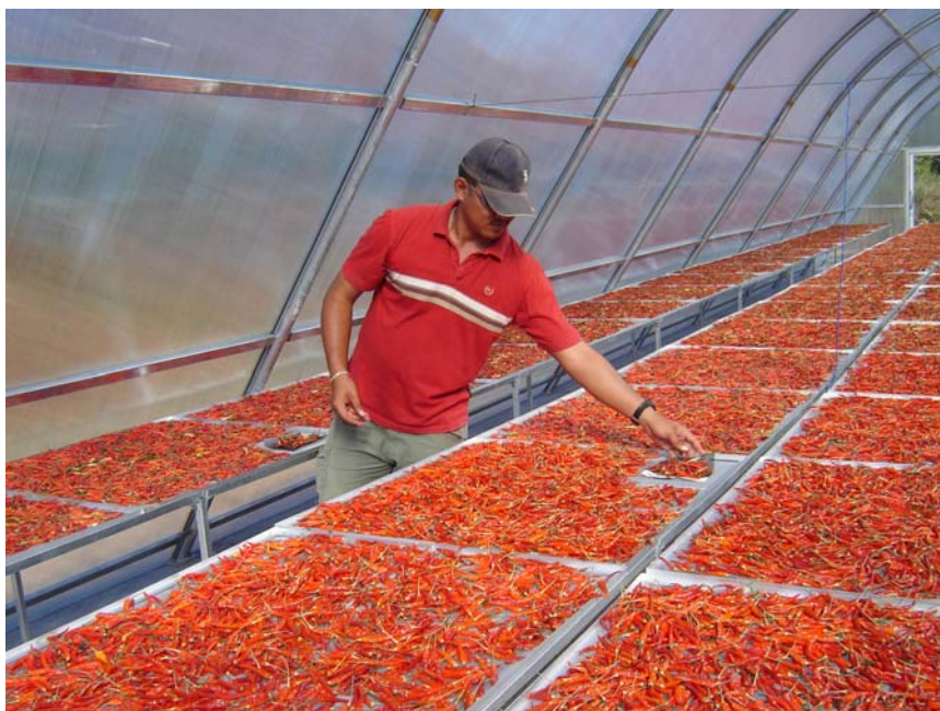
รูปที่ 3.71 แสดงการอบแห้งพริกด้วยระบบอบแห้งพลังงานแสงอาทิตย์ แบบเรือนกระจก ณ องค์การบริหารส่วนตำบลหัวเรือ
