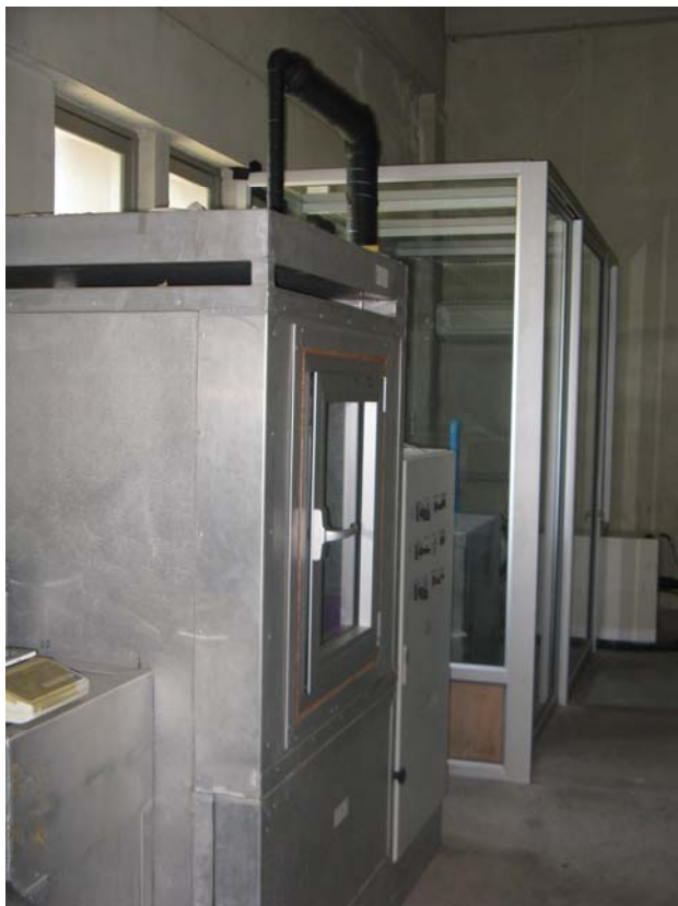
รูปที่ A1.2 เครื่องอบแห้งระดับห้องปฏิบัติการ (laboratory dryer) ที่จะใช้ในการทดลองเพื่อหาสมการการอบแห้งชั้นบาง
