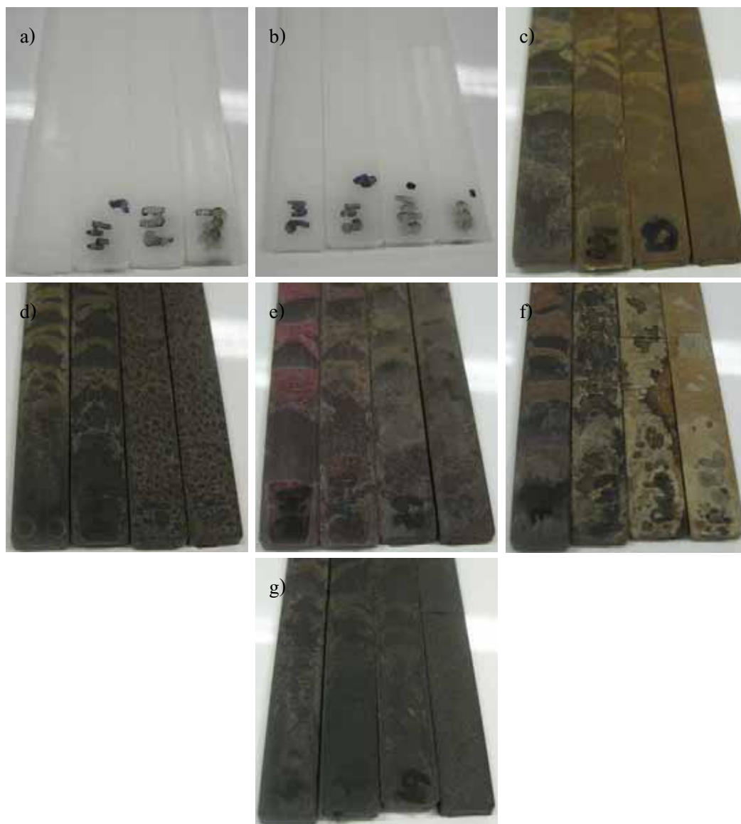
ภาพที่ 32 แสดงภาพถ่ายการเปลี่ยนแปลงลักษณะทางกายภาพของชิ้นงานทดสอบทั้งก่อนตากแดดและหลังตากแดดเป็นเวลา 1, 2 และ 3 เดือน (จากซ้ายไปขวา) โดยที่ a) HDPE, b) MA-HDPE, c) WPE, d) D-WPE, e) DR-WPE, f) RT-WPE และ g) SP-WPE
