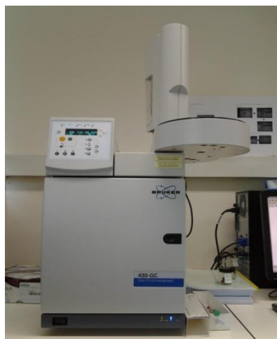
ภาพที่ 3.2 เครื่อง GC (Gas Chromatography, GC-430, Bruker )
