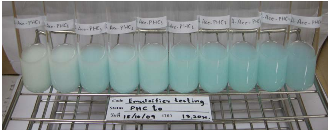
รูปที่ 26 การทดลองผสม Polyoxyethylene 40 hydrogenated castor oil (PHC) , 20% Acesulfame-K และ น้ำมันมะกูด ที่ความเข้มข้นต่างๆของ PHC (0.4-5.66%)
