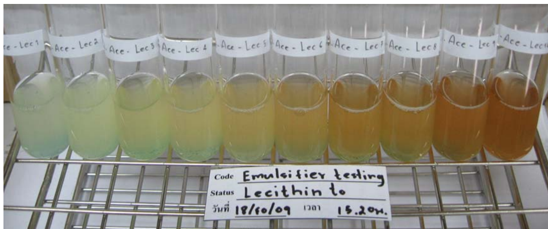
รูปที่ 27 การทดลองผสม Lecithin , 20% Acesulfame-K และ น้ำมันมะกูด จากซ้ายไปขวา หลอดที่ 1 ส่วนประกอบต่างๆ ในน้ำ, หลอดที่ 2-9 ส่วนประกอบต่างๆในน้ำมันมะกูด ที่ความเข้มข้นต่างๆ ของ Lecithin (0-5.66%)
