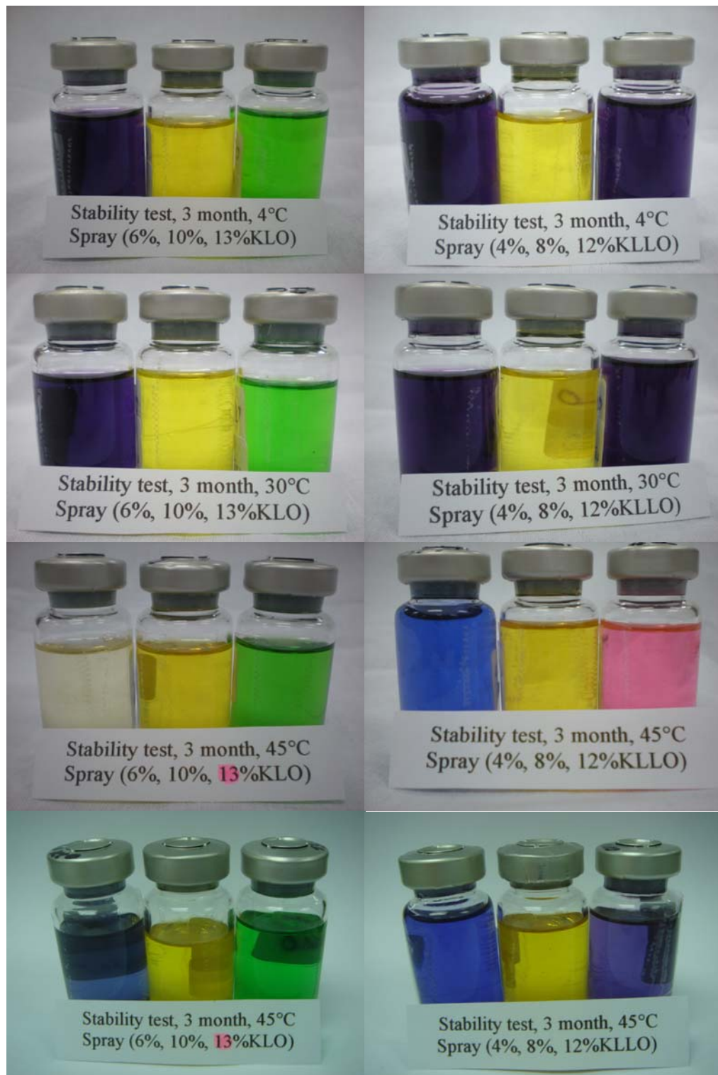
รูปที่ 46 ผลิตกัณฑ์ชนิดฉีดพ่นในปากจากน้ำมันมะกรูด (KLO) และน้ำมันใบมะกรูด (KLLO) ที่ 3 เดือน อุณหภูมิ 4, 30, 45 องศาเซลเซียส (รูปแถวที่ 3 และ 4, 6%KLO มีการเปลี่ยนแปลงของสีจากสีม่วงเป็นสี ม่วงอ่อน (ในรูปเห็นเป็นสีฟ้า) หรือสีเหลืองอ่อน, 4%KLLO มีการเปลี่ยนแปลงของสีจากสีม่วงเป็นสีม่วง อ่อน (ในรูปเห็นเป็นสีฟ้า), 12%KLLO มีการเปลี่ยนแปลงของสีจากสีม่วงเป็นสีม่วงอ่อนหรือสีชมพูอ่อน)
