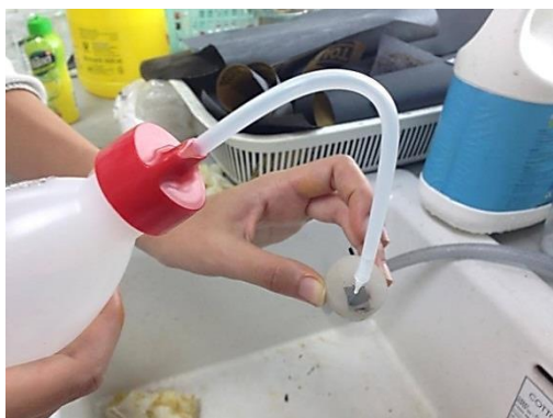
รูปที่ 3.10 ทำความสะอาดชิ้นงานด้วยอะซิโตน
