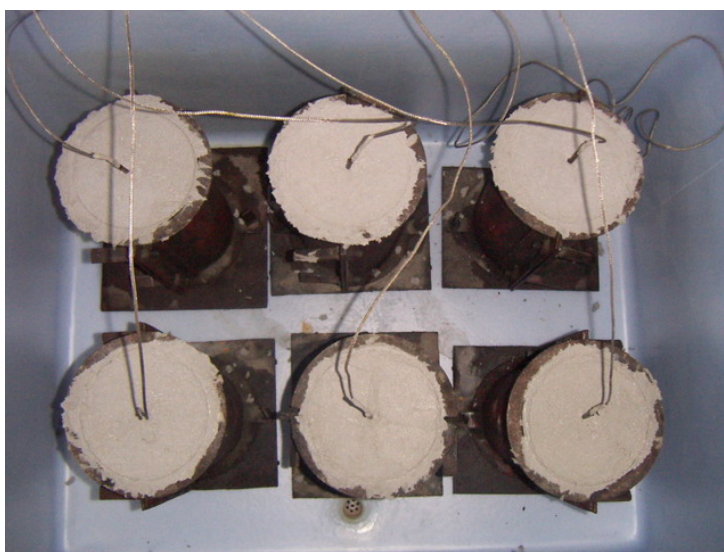
ภาพที่ 23 เครื่องมือสำหรับบันทึกอุณหภูมิและการติดตั้งเทอร์โมคอปเปิ้ลในตัวอย่างคอนกรีต
