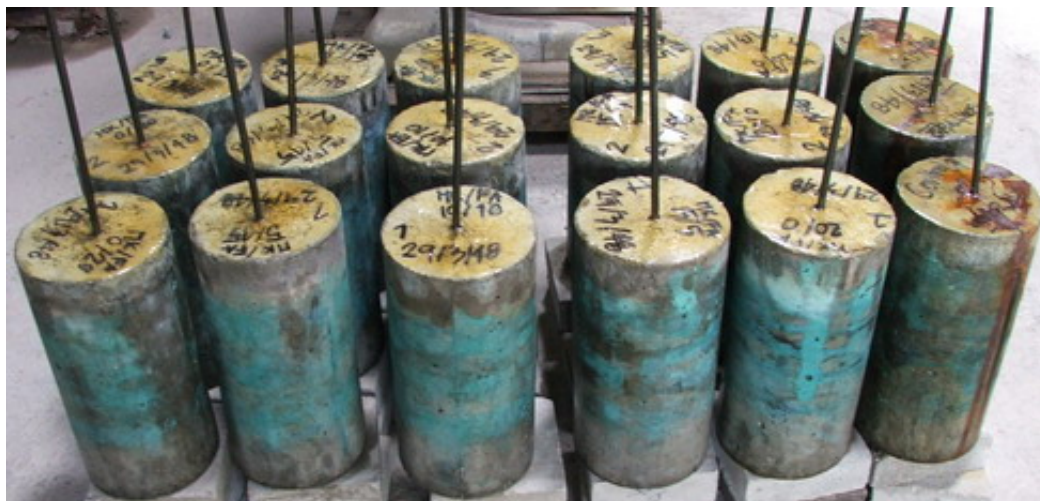
คอนกรีตผสมดินขาวและเถ้าลอยเร่งสนิมด้วยกระแสไฟฟ้าระยะเวลา 91 วัน
