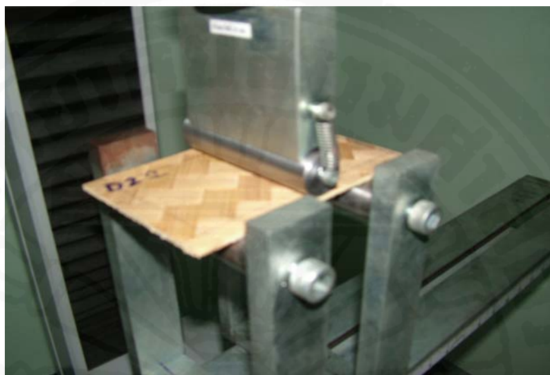
ภาพที่ 3.32 ความต้านแรงดัดโดยใช้เครื่อง Testometric
