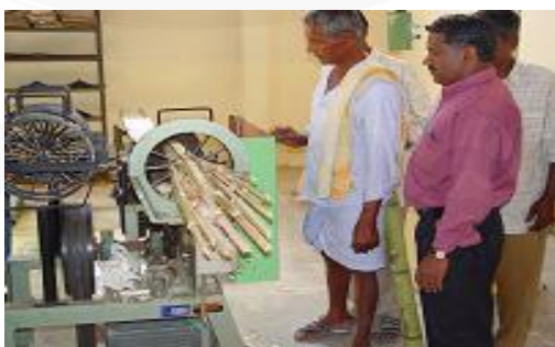
ภาพที่ 2.5 การผ่าไผ่โดยใช้เครื่องจักร
