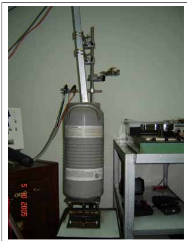
รูป ง.16 แสดงภาพถังบรรจุไนโตรเจนเหลวขณะแช่เม็ดสารตัวอย่าง
