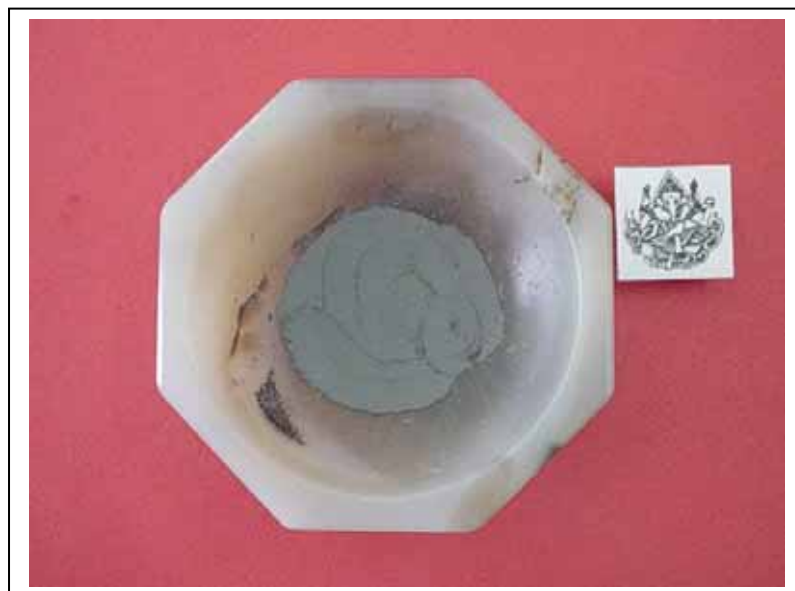
รูป ง.4 แสดงภาพครกหินอ่อนที่มีสารตั้งต้นบดคลุกเคล้าจนเป็นเนื้อเดียวกัน
