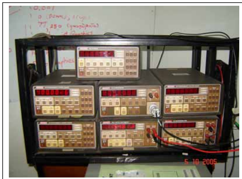
รูป ง.14 แสดงภาพเครื่องวัดความต่างศักย์และแหล่งจ่ายกระแสไฟฟ้าคงที่
