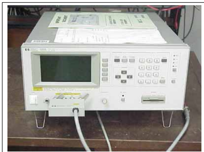
รูป ง.13 แสดงภาพเครื่องวัด Precision LRC HEWLETT PACKARD รุ่น 4284A
