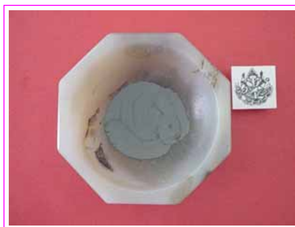
รูป 3.5 แสดงผงสารประกอบตั้งต้นที่บดคลุกเคล้ากันเป็นอย่างดีในครกหินอ่อน
