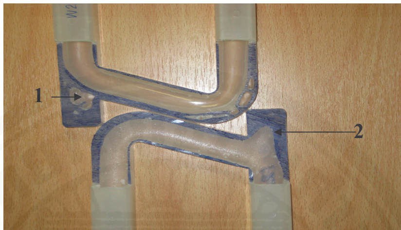
ภาพที่ 4.6 แสดงผิวของช่องกลวงจากการฉีดโดยใช้น้ำช่วย (บน) และใช้แก๊สช่วย (ล่าง)
