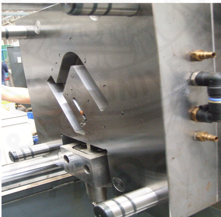
ภาพที่ 4.2 แสดงแม่พิมพ์ที่ใช้ร่วมกับเครื่องอัดน้ำแรงดันสูง
