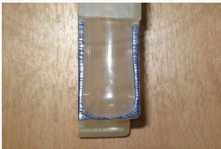
ภาพที่ 4.3 แสดงภาพตัดของส่วนปลายสุดของชิ้นงานที่บางมากเกินไป
