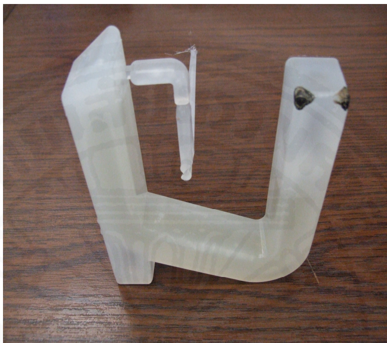
ภาพที่ 4.5 แสดงส่วนปลายสุดของชิ้นงานที่เกิดการอันอากาศและไหม้
