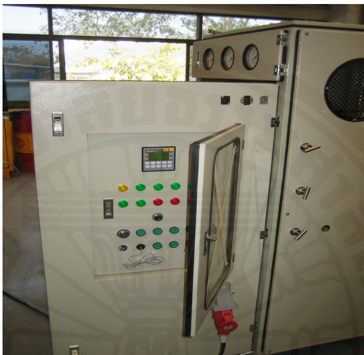
ภาพที่ 4.1 แสดงเครื่องอัดน้ำแรงดันสูงที่ออกแบบและสร้างขึ้น
