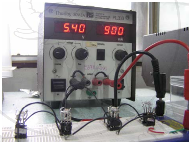
รูปที่ 4.12 แสดงการอบเซนเซอร์ก๊าซโดยใช้ Power supply ยี่ห้อ Thurlby รุ่น PL 310 ของบริษัท RS Components จำกัด
