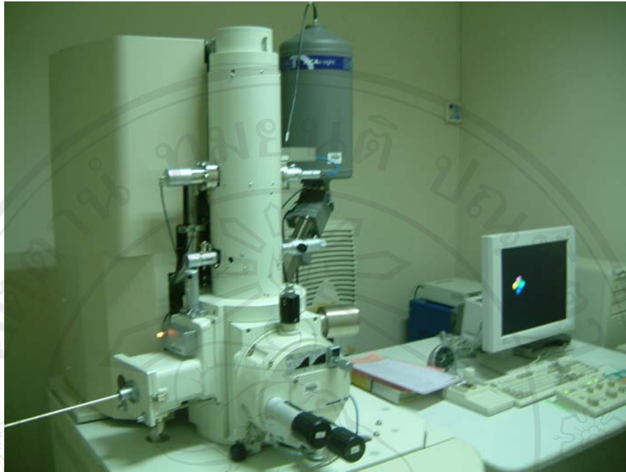
รูปที่ 3.13 แสดงกล้องจุลทรรศน์อิเล็กตรอนแบบส่องกราด (Scanning Electron Microscope, SEM) ที่ศูนย์วิจัยและบริการจุลทรรศน์ศาสตร์อิเล็กตรอน (EMRSc) คณะวิทยาศาสตร์ มหาวิทยาลัยเชียงใหม่
