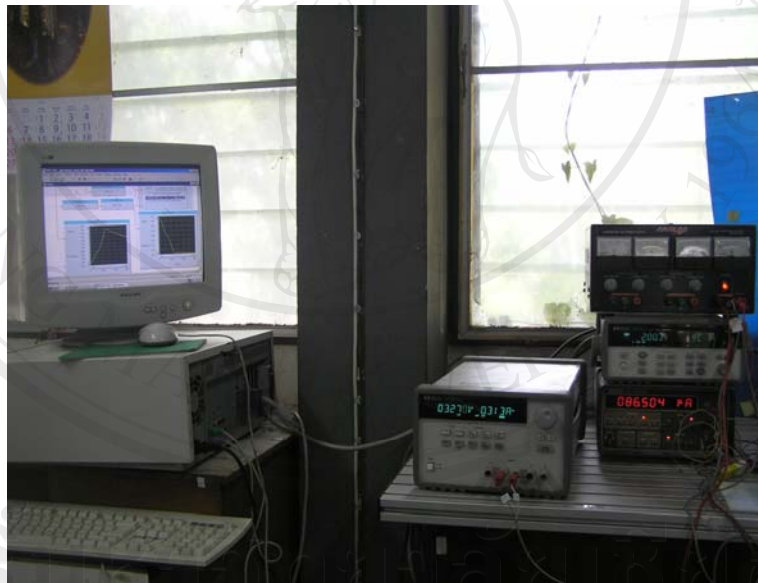
รูปที่ 3.19 แสดงชุดทดสอบสมบัติการตรวจจับก๊าซของเซนเซอร์ก๊าซ ที่ห้องวิจัยฟิสิกส์ประยุกต์ ภาควิชาฟิสิกส์ คณะวิทยาศาสตร์ มหาวิทยาลัยเชียงใหม่
