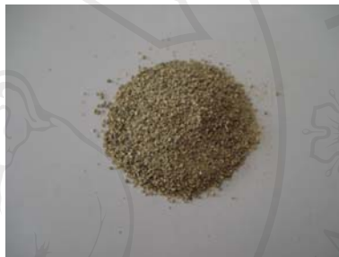
คอร์เดียไรต์
