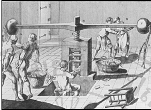
ภาพที่ 1.3 เครื่องผลิตเหรียญที่ใช้แรงคนหมุน (Screw Press Machine)
