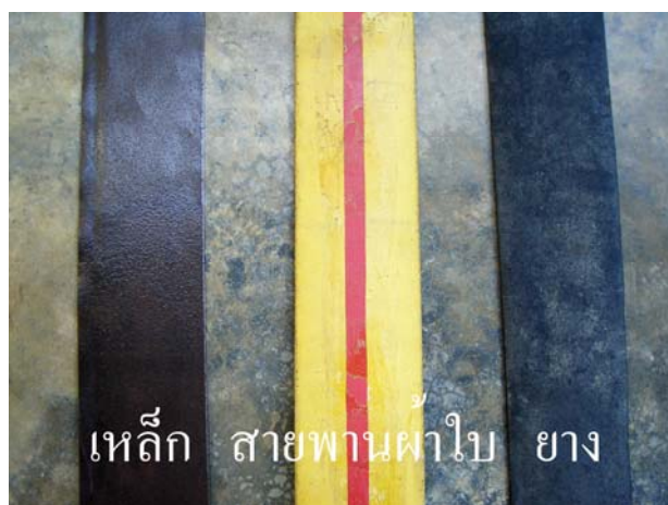
ภาพที่ 14 แผ่นเป่ากระทบเมล็ดทานตะวัน(แบบใช้แรงเหวี่ยงแกนเพลานวนอน)
