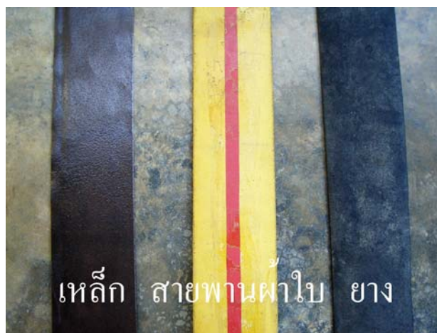
ภาพที่ 18 แผ่นเป่ากระทบเมล็ดทานตะวัน(แบบใช้แรงเหวี่ยงแกนเพลานวนตั้ง)
