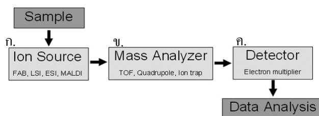
ภาพที่ 9 องค์ประกอบสำคัญ 3 ส่วนของเครื่องวัดสเปกตรัมมวล ก.) แหล่งกำเนิดประจุ ข.) เครื่องวิเคราะห์มวล และ ค.) เครื่องตรวจวัด
