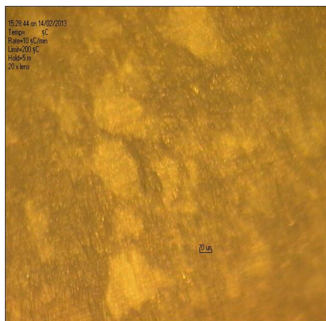
รูปที่ 4.12 ภาพตัดขวางของวัสดุรีไซเคิลจากเศษเมลามีน 40%
